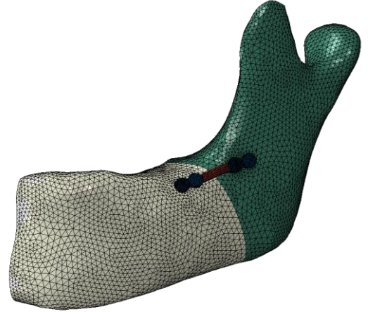
Şekil 3.5: Ağ yapısı oluşturulmuş uygun olmayan kırık modeli
