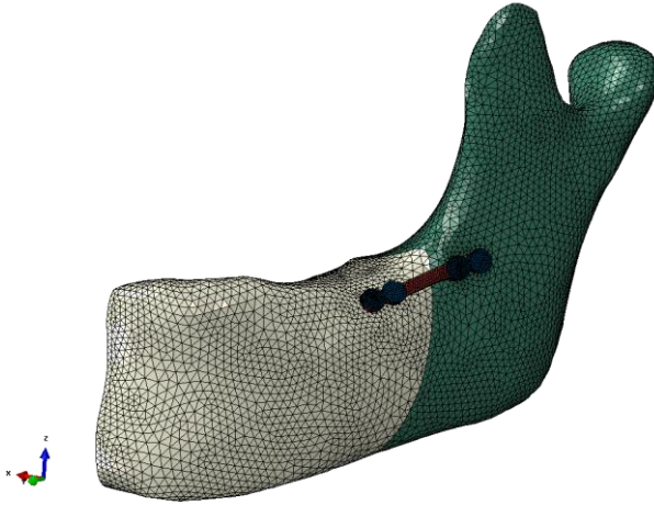
Şekil 3.4: Ağ yapısı oluşturulmuş uygun kırık modeli
