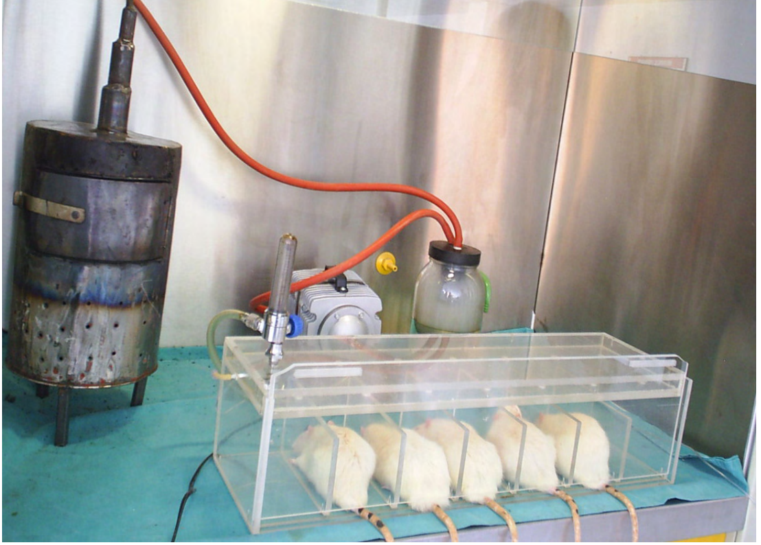
Resim 2. Duman inhalasyon hasarı oluşturmak için kullanılan düzenek
