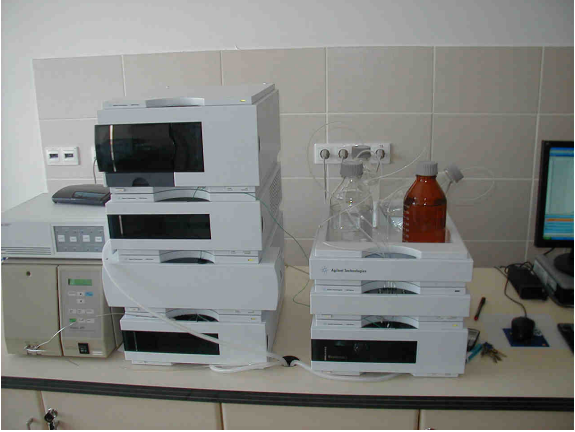
Şekil 3.1 Agilent Technologies 1200 serisi (Quaternary pompası, Diode Array ve Multiple Wavelength detektör, vakum degaser, termostatlı autosampler ve kolon ısıtıcısı)
