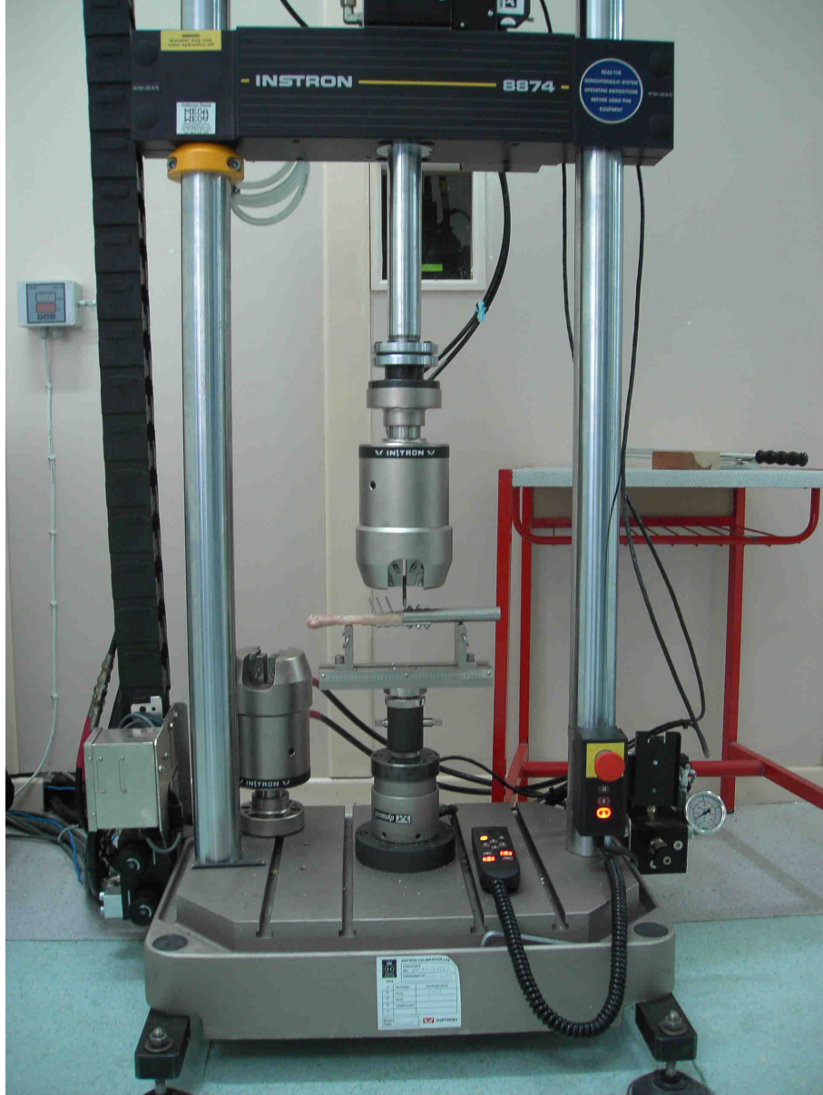
Şekil 3.9. Eğilme testleri genel sistem görüntüsü
