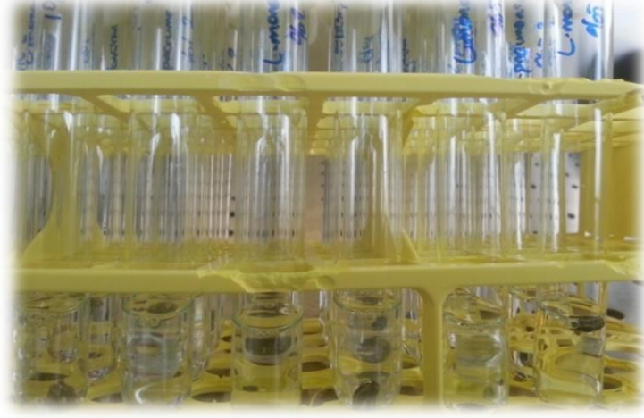
Şekil 3.11 %1'lik Tween 80 ile yıkanan diskler
