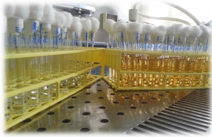
3.12 %1lik Tween 80 ile yıkanan diskler ve inkübasyon için hazırlanan MHB
