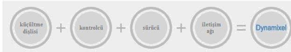
Şekil 4.4 Dynamixel aktüatör hepsi bir arada yapısı
