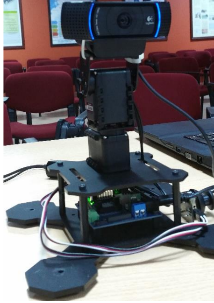
Şekil 5.24 Hedef izleme ünitesi görünümü
