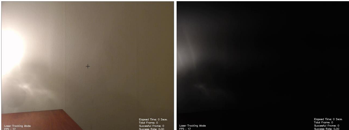
Şekil 5.8 Lazer izleme bölümünde, kameranın pozlandırma süresi ve kazanç değerlerinin değiştirilmesi ile görüntünün parlaklık seviyesinin düşürülmesi
