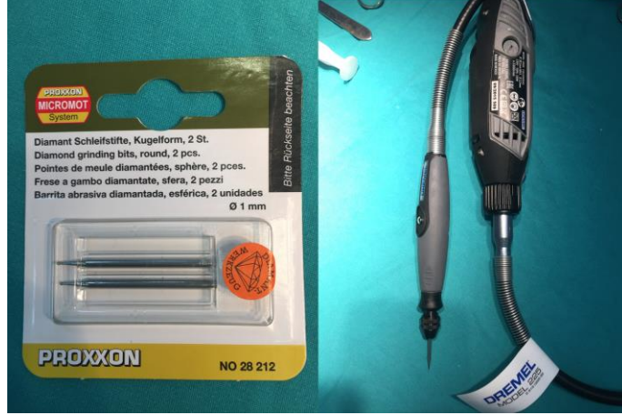
Şekil 3.15: Çalışmada kullanılan tur motoru ve elmas ucu
