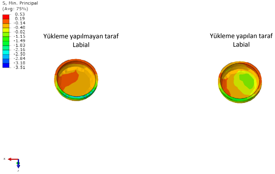
Şekil 4.136: 1. tasarımda housing parçada oluşan basma stresleri
