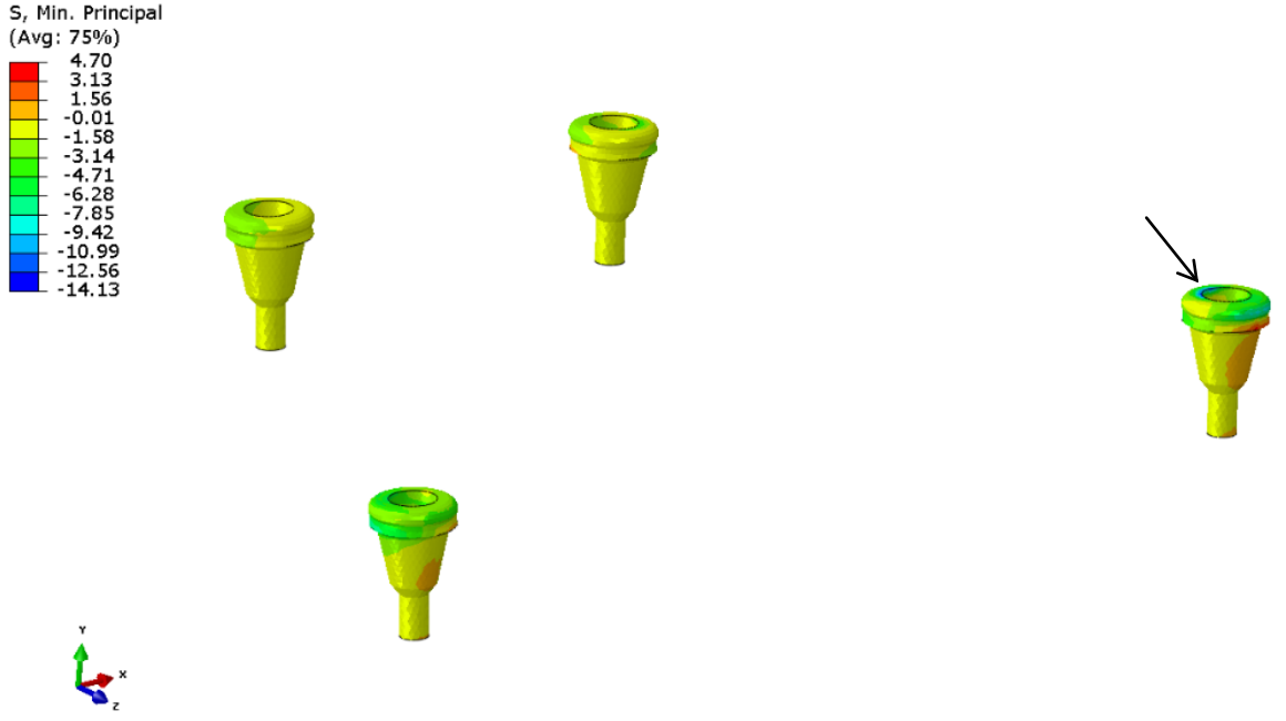
Şekil 4.155: 4. tasarımda locatorlarda oluşan basma stresleri
