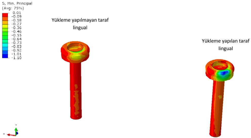
Şekil 4.153: 2. tasarımda locatorlarda oluşan basma stresleri
