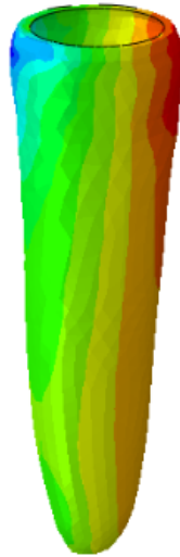
Şekil 4.109: 3. tasarımda PDL'de oluşan basma stresleri
