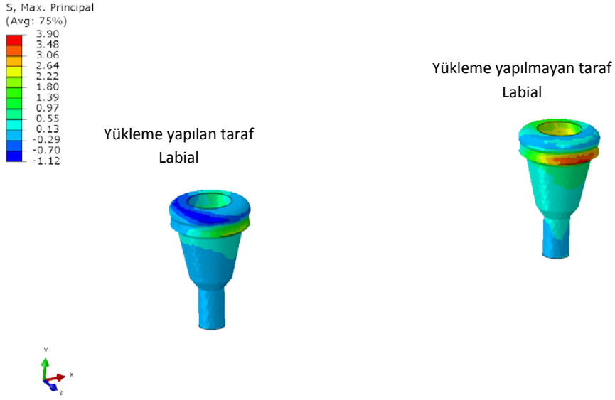
Şekil 4.147: 1. tasarımda locatorlarda oluşan çekme stresleri
