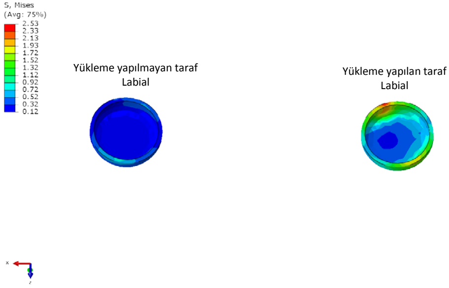
Şekil 4.142: 2. tasarımda housing parçada oluşan von Mises stresleri
