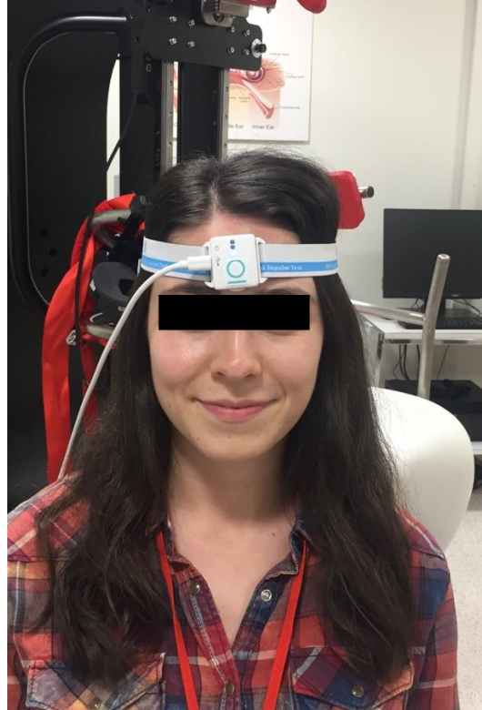
Şekil 3.2. Jiroskopun elastik bant ile başa tutturulması
