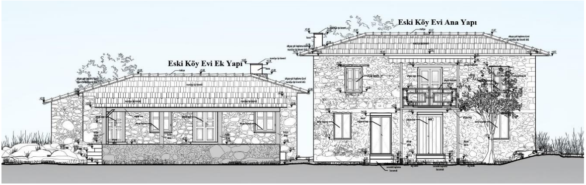
Şekil 5.36. Alandaki eski köy evlerinin ön cephe rölöve çizimi
