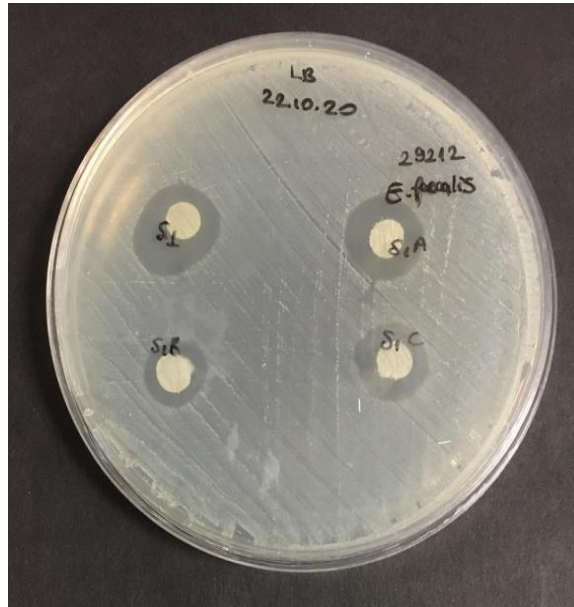
Şekil 4.26. Yeşil LED ile aktive edilen AgNP/CMC/MA/ODA-MMT numunesinin farklı konsantrasyonlarda (S1: 2,5 mg/ml, S1A:0,5 mg/ml, S1B: 0,1 mg/ml, S1C: 0,05 mg/ml) E. faecalis 29212 bakterilerine karşı antibakteriyel aktivitesi.
