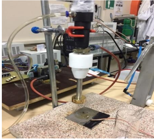
Şekil 3.12. Tasarım C plakalı ve altın elektrot tipi
