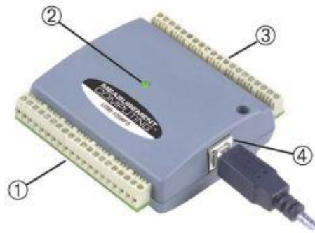
Şekil 3.12. MCC DAQ Card USB-1208FS [46]
