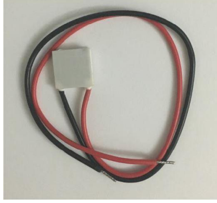
Şekil 3.11. Uyarıcı olarak seçilen termoelektrik modül
