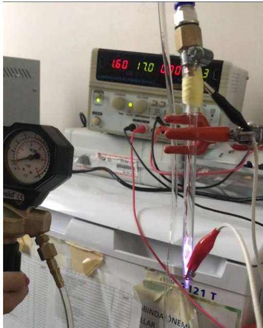
Şekil 3.16. Sistem test çalışmalarında elde edilen ilk plazma akışı
