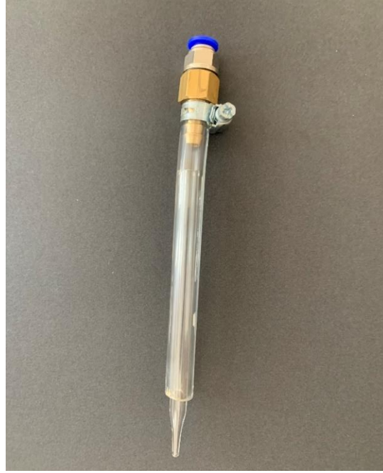
Şekil 3.11. Medikal plazma probu ikinci tasarım yapılandırılması
