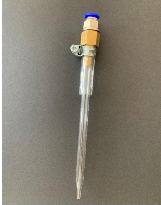
Şekil 3.12. Medikal plazma probu kuartz cam yapılandırılması
