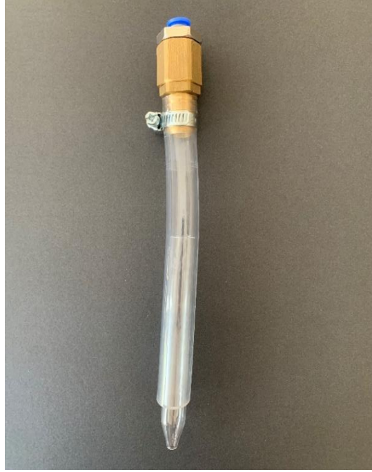
Şekil 3.10. Medikal plazma probu ilk tasarımın yapılandırılması
