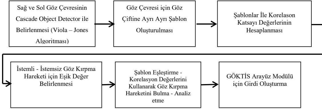
Şekil 2.3. Göz kırpma hareketi için görüntü işleme adımları
