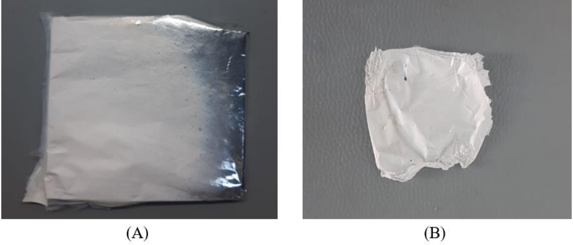
Şekil 4.2. Elde edilen ipek fibroin (%15 w/v) nanofiber yapılar (A) alüminyum folyoya kaplanmış fiberler, (B) Alüminyum folyodan sıyrılmış ve çapraz bağlanıp kurutulmuş fiber görüntüsü.
