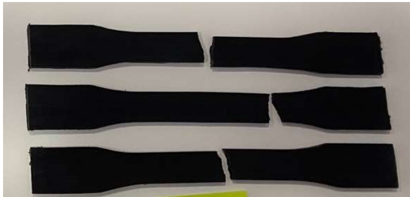
Őekil 5.12 ekme Testi Sonrası Numune F
