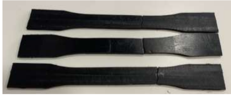
Şekil 5.8 Çekme Testi Sonrası Numune D
