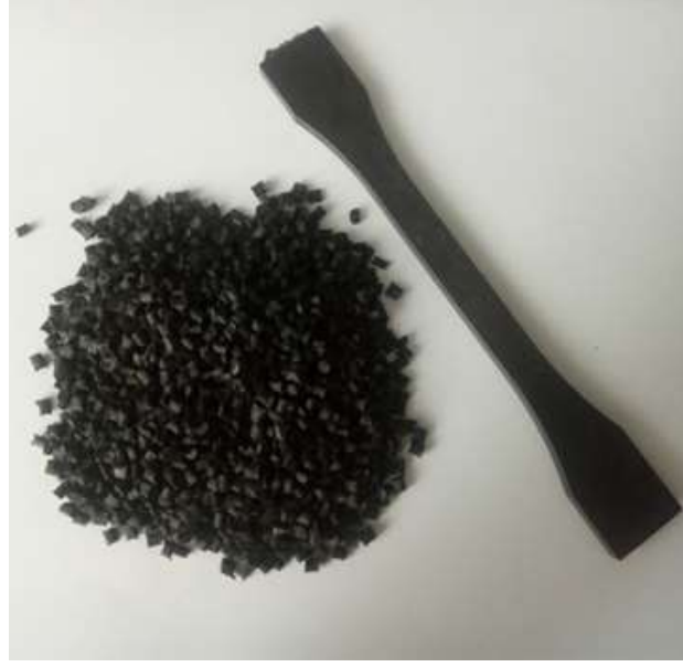
Şekil 3.2 Plastik enjeksiyon işleminde kullanılan cam takviyeli PA granülleri ve çekme test numunesi [68]
