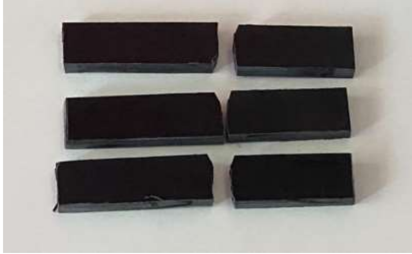
Şekil 5.17 Darbe deneyi sonrası Numune E
