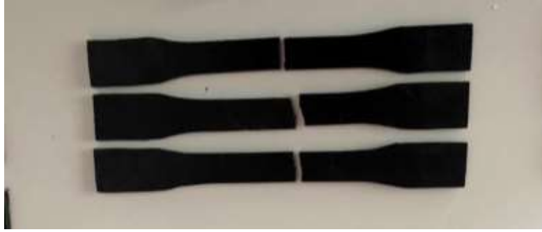
Şekil 5.10 Çekme Testi Sonrası Numune E
