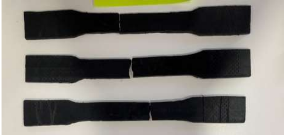
Şekil 5.16 Çekme Testi Sonrası Numune H
