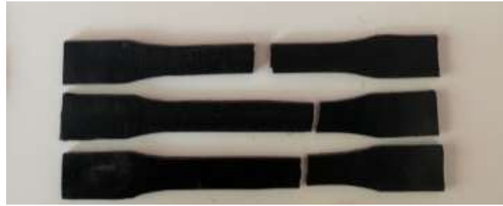
řekil 5.4 Çekme Testi Sonrası Numune B
