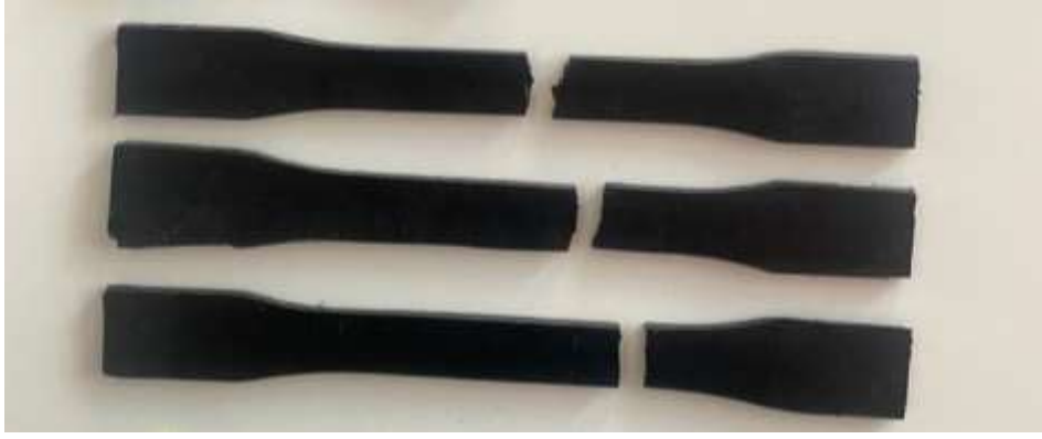
Şekil 5.6 Çekme Testi Sonrası Numune C
