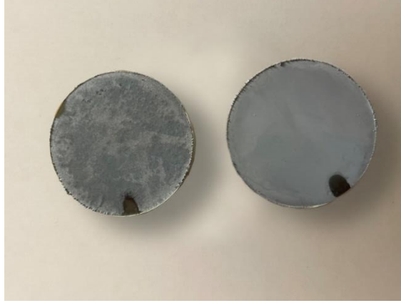
Şekil 3.12. Tribometre Deneyinde Kullanılan Numuneler (a. Numune 5) (b. Numune 6)
