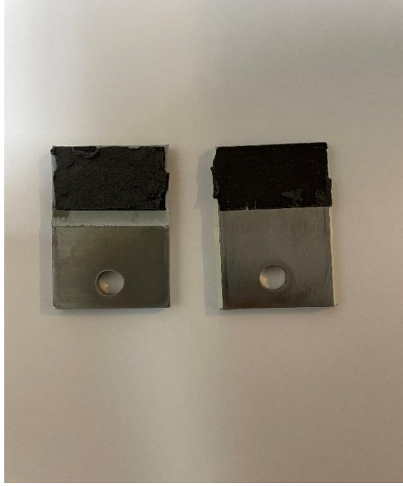
Şekil 4.32. Numune 6'ın ASTM F 1044 – 99 Standardına Göre Yapışma Mukavemeti Analizi Sonrası Test Numunesi (a. Kaplanmış Numune) (b. Kaplanmamış Numune)
