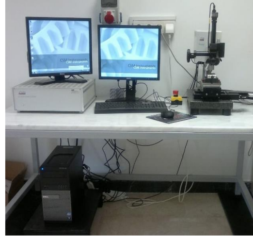
Şekil 3.17. a. Çizik Test Şematik Gösterimi ve b. CSM Makro Çizik Test Cihazı
