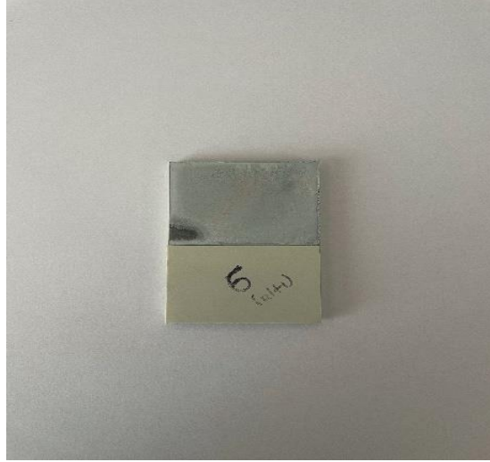
Şekil 4.4. Zn-ZrO 2 Kaplanmış Numune 6
