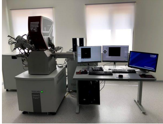
Şekil 3.10. Tescan Marka GAIA+30XFORD XMAX Model SEM Cihazı[32]
