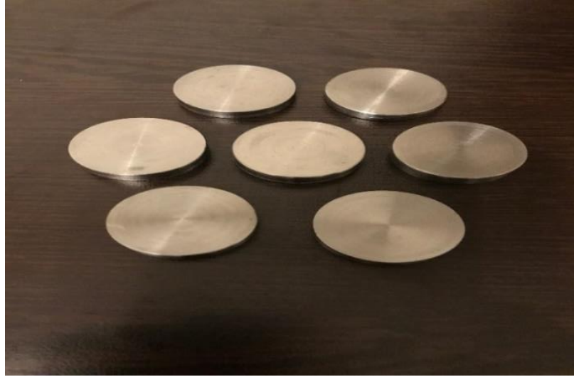
Şekil 3.2. Kaplama Öncesi 30mm Çapındaki TI6Al4V Numuneleri
