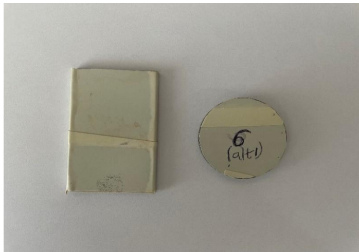
Şekil 3.4. Elektro Kaplama Bantı ile Kaplanmış Numuneler
