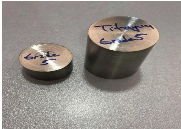
Şekil 3.1. Silindirik TI6Al4V Numuneler
