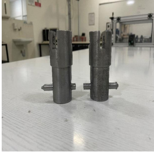
Şekil 3.15. ASTM F 1044- 99 Standardına Uygun Tasarlanmış Numune Tutucular
