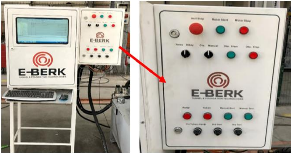
Şekil 3.7. Kesme Deney Seti Kontrol Paneli
