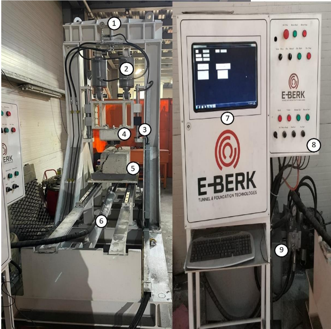
Şekil 3.5. Kesme Deney Seti (1. Basınç Sensörü,2. Normal Kuvvet Pistonu,3. Penetrasyon Sensörü,4.Kesici Disk ve Yataklama Elemanı,5.Deney Materyeli, 6.Yuvarlanma Kuvveti Pistonu, 7. Kullanıcı Ekranı, 8. Kontrol Panosu, 9. Hidrolik Ünite)
