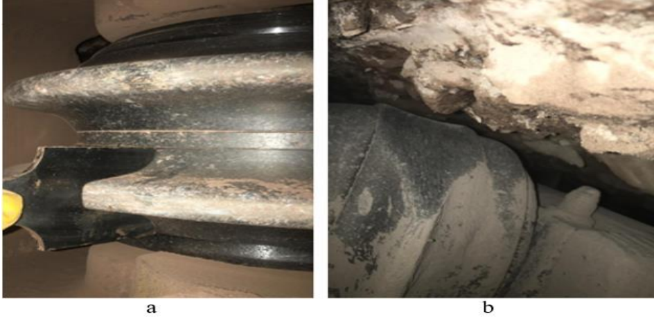
Şekil 2.6. Kesici Disk Kontrollü (a) ve Tek Yönlü Aşınan Kesici Disk (b)
