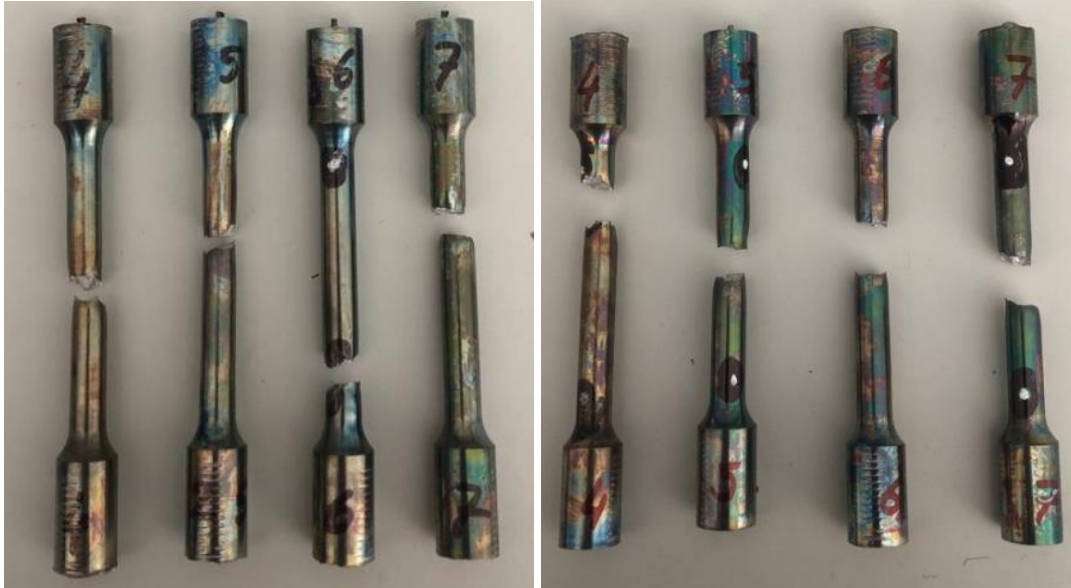
Şekil 44 HIP Sonrası P1 ve P2 numunelerine ait çekme testi sonucu kopan görüntüleri
