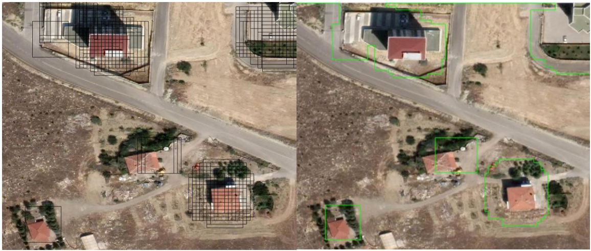
Şekil 3.16. Tarama Algoritması ile Test Görüntüsünde Bina Bölge Tespiti (sol) ve Sadeleştirme sonucu (sağ)
