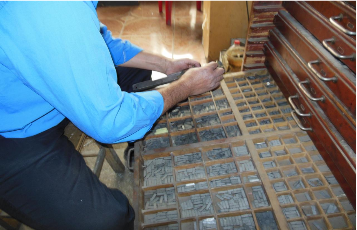
Ek 25. Tipo baskı makinesinde kullanılan kurşun harfler ve kumpas
