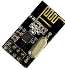
Şekil 4.13 NRF24L01 Kullanan Kablosuz Haberleşme Modülü
