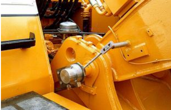
Şekil 1.6 IHC Firmasının Göreceli Pozisyon Sensörü [6]
