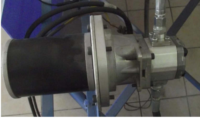
Şekil 3.30 Doğru Akım Motoru ve Hidrolik Pompa
