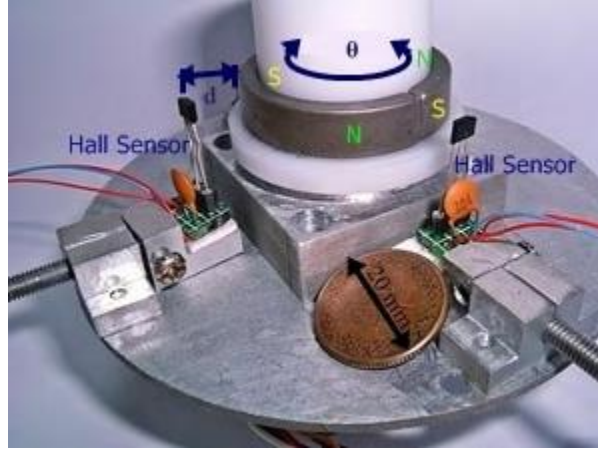
Şekil 1.3 Lee ve Arkadaşlarının Çalışmalarındaki Manyetik Pozisyon Algılayıcısı [3]
