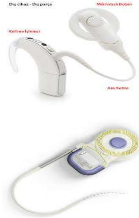
Şekil 1: Koklear implant dış ve iç parçaları
