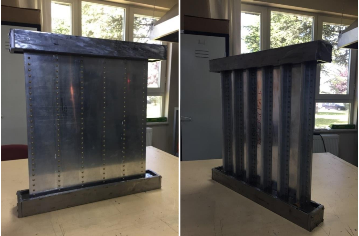
Şekil 3.3 Test Panelinin Alt ve Üst Kenarlarına Uygulanan Destek Blokları
