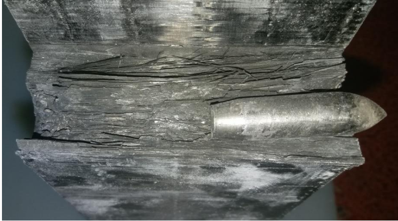
Şekil 3.12. Sensörsüz Büyük Panel-1’ deki 1 Numaralı Atışta Merminin İsabet Ettiği Kompozit Bloğun İç Yüzey Görünümü
