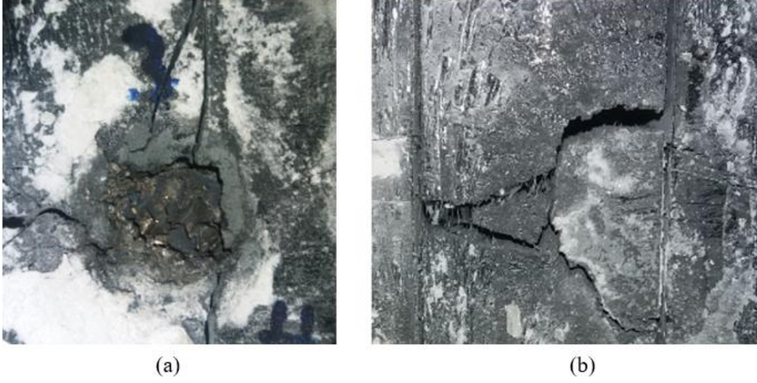
Şekil 3.15. Sensörsüz Büyük Panel-1' deki 3 Numaralı Atışta Merminin İsabet Ettiği Kompozit Bloğun Önden (a) ve Arkadan (b) Görünümü
