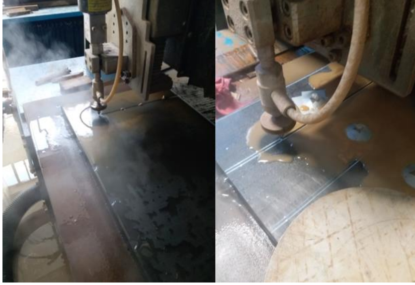
Şekil 2.16. Kompozit Parçaların Su Jeti ile Kesilmesi
