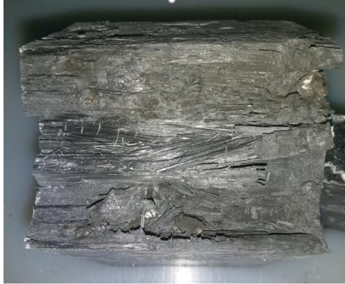
Şekil 3.18. Sensörsüz Büyük Panel-1’ deki 4 Numaralı Atışta Merminin İsabet Ettiği Kompozit Bloğun İç Yüzey Görünümü
