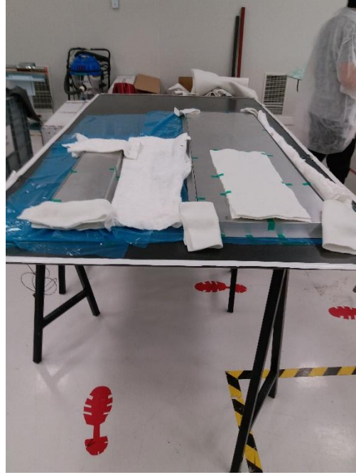
Şekil 2.12. Baskı Plakaları ve Profiller Üzerindeki Vakum Battaniyesi
