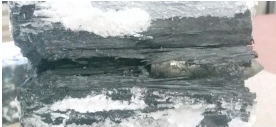
Şekil 3.21. Sensörlü Büyük Panel-2' deki Merminin İsalet Ettiği Kompozit Bloğun İç Yüzey Görünümü
