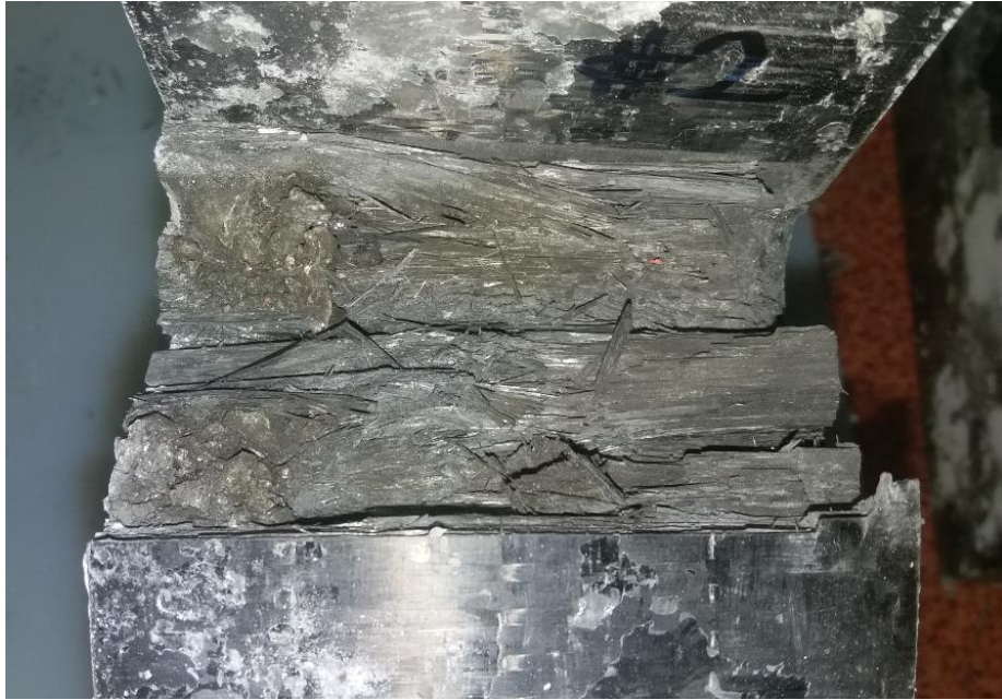
Şekil 3.14. Sensörsüz Büyük Panel-1' deki 2 Numaralı Atışta Merminin İsabet Ettiği Kompozit Bloğun İç Yüzey Görünümü
