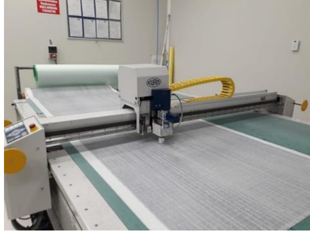
Şekil 2.3. Karbon Fiber Epoksi Prepreg Malzemelerin CNC Katman Kesici ile Kesimi
