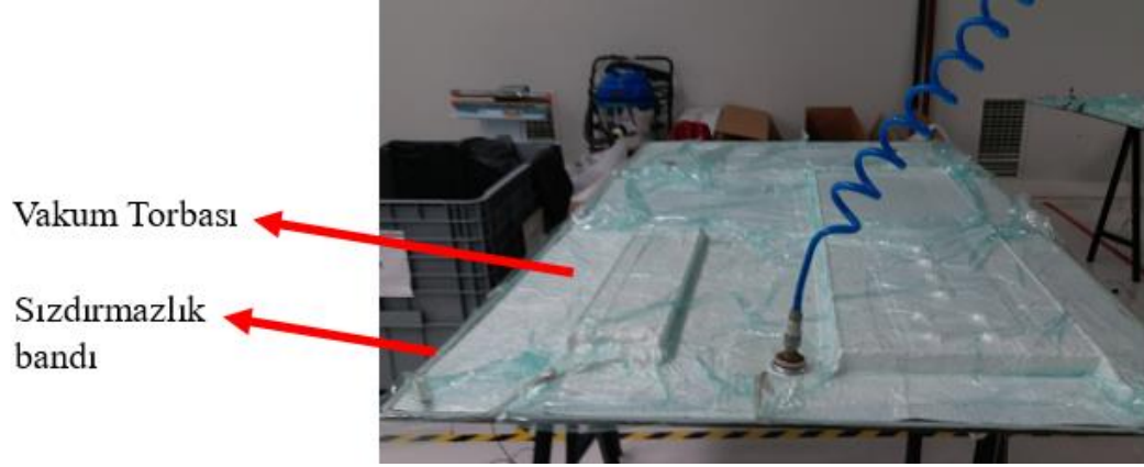
Şekil 2.14. Karbon Fiber ile Takviye Edilmiş Parçaların Vakumlama İşlemi
