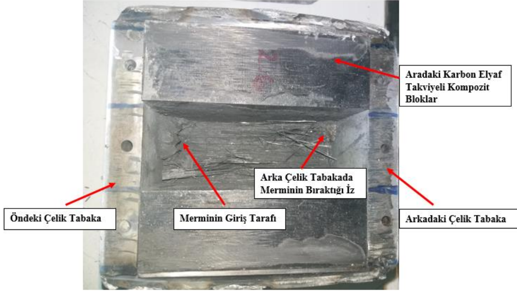
Şekil 3.7. Küçük Panel-1' in İç Yüzeyi
