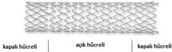
Şekil 10: Açık ve kapalı hücreli stent yapısı
