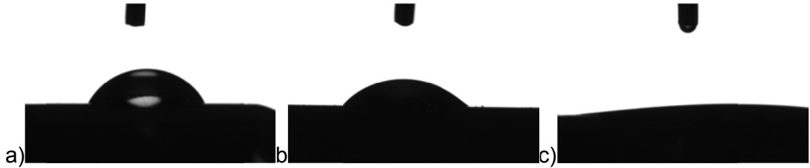
Şekil 4.22 a) İşlem görmemiş vida, b) 45W, 10ml/dak, 6 dakikada kaplanan vida c) 45W, 10ml/dak, 6 dak aktive edilmiş vida
