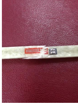
Şekil 5.7 Çekme deneyi sonrasında hasara uğramış çekme numunesi
