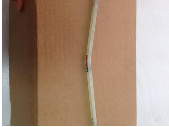
Şekil 5.11 Eğilme deneyi sonrasında hasara uğramış eğilme numunesi
