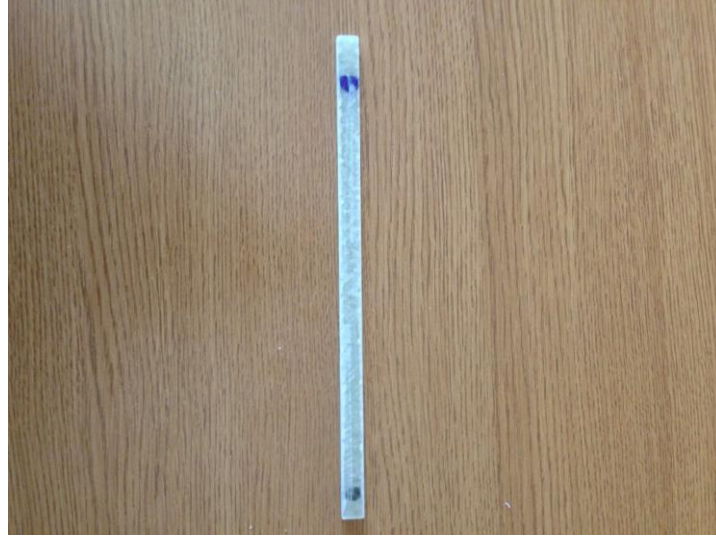
Şekil 5.9 Epoksi-ECam malzemesinden yapılan eğilme numunesi
