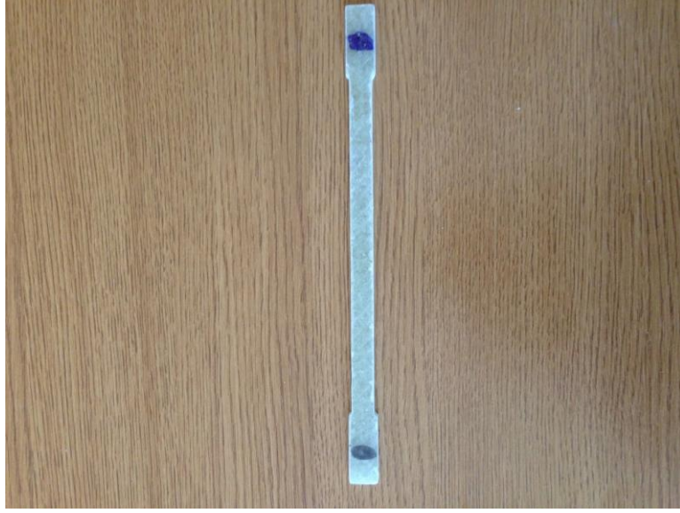
Şekil 5.4 Epoksi-ECam malzemesinden yapılan çekme numunesi
