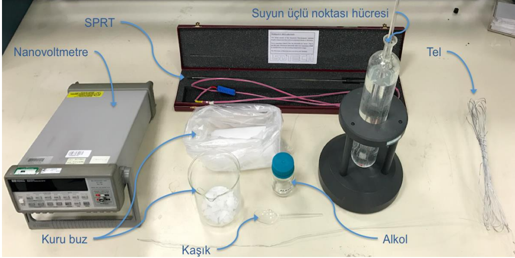
Şekil 4.2 Suyun Üçlü Noktası Deneyi Malzemeleri
