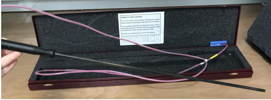
Şekil 4.7 Standart Platin Direnç Termometresi
