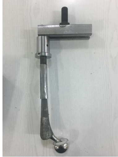
Şekil 3.3: Asetabulumaya Yük İletimini Sağlayan Femoral Stem ve Baş
