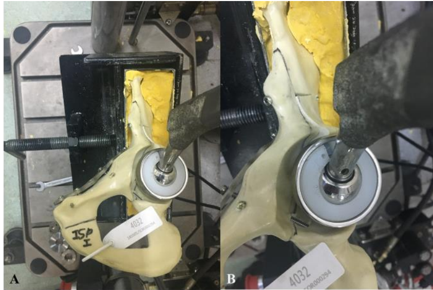
Şekil 4.3: Üçüncü grupta implant yetmezlikleri A: İliak kanada giden X hattında ayrışma B: X ve Y hattında ayrışma ile yetmezlik gelişimi
