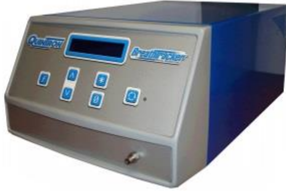
Şekil 3: Gaz Analizi ve Ölçümü İçin Kullanılan Quintron Breathalyzer SC Cihazı
