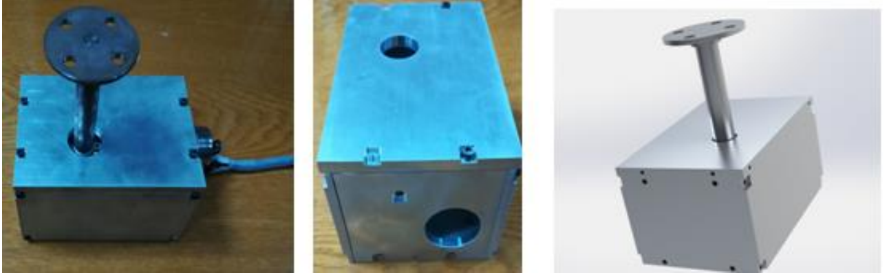
Şekil 6.6 Kuvvet Ölçüm Düzeneginin Dış Aksamında Kullanılan Özel Üretim Parçalar
