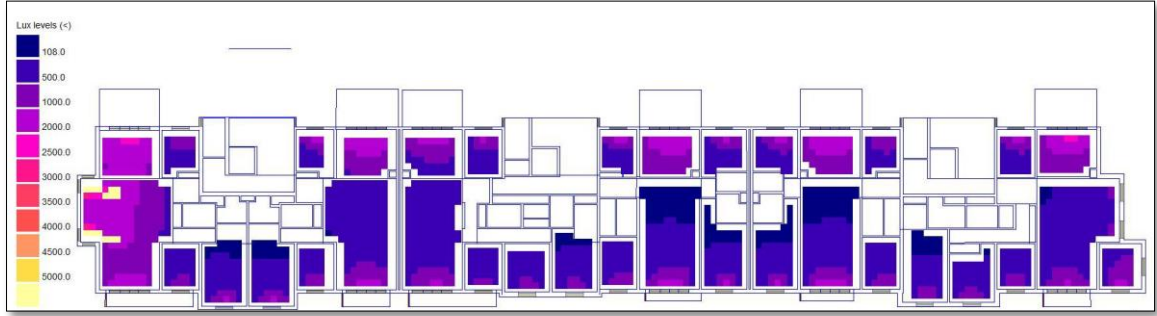
Şekil 35. Park Mozaik D Blok Zemin Kat Planı 21 Eylül saat 15:00 Gün Işığı Dağılımı (Ecobuild Bina Gün Işığı Analiz Raporu, 2018)
