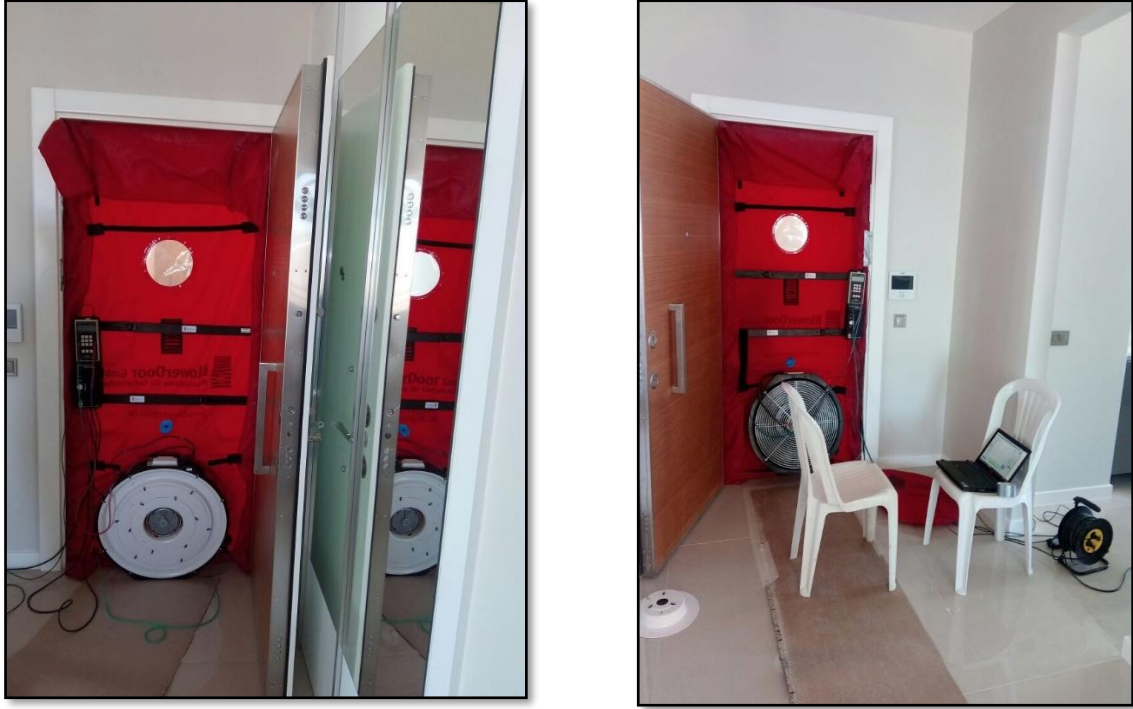
Şekil 14. Blower (basınç) Door Testi (Ekho Sızdırmazlık, 2018)
