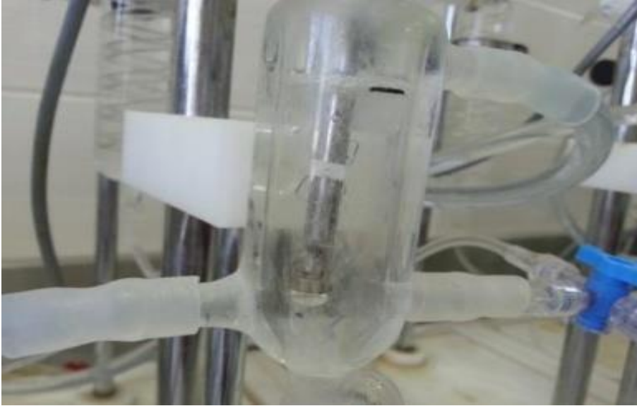
Şekil 3.1. İzole organ banyosuna asılmış bir sıçan izole torasik aorta halka preparatı. Çözelti, deney boyunca sürekli olarak %95 O 2 ve %5 CO 2 karışımı ile gazlandırıldı.
