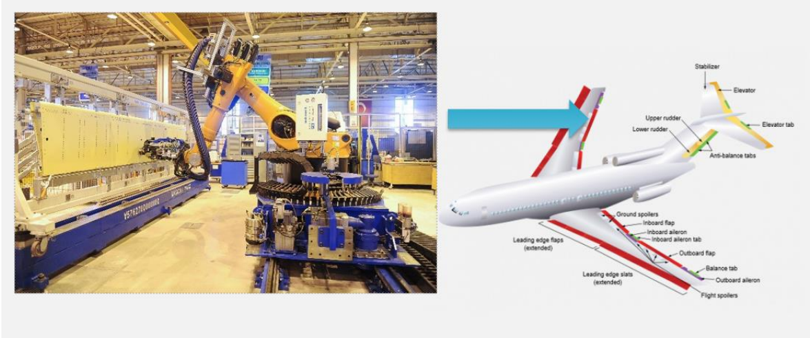
Şekil 1.3 Uçak kanatçığı (sağda) montajının robotik kontrol ile delinebilmesi için tasarlanıp üretilmiş bir takım (solda)
