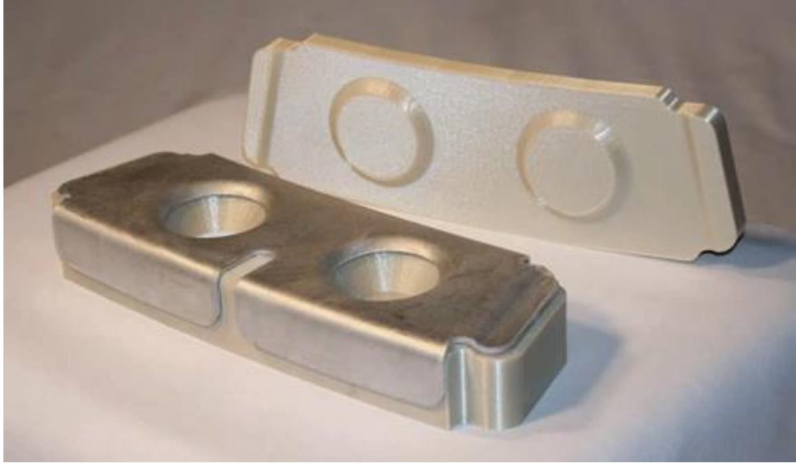
Şekil 1.4 Alüminyum bir hava aracı yapısalı parçasını üretmek için üç boyutlu yazıcı ile imal edilmiş bir hidroform 2 şekillendirme kalıbı
