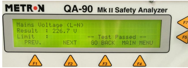
Şekil 38. Cihaz-toprak arası voltaj ölçüm test sonucu (L-N)(Faz-Nötr)
