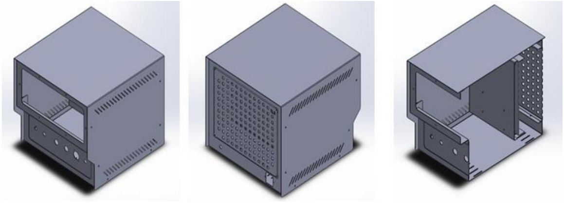
Şekil 22. Oluşturulacak kontrol ünitesi-panel tasarımının 3B modellemesi
