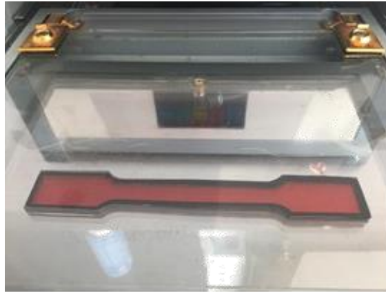
Şekil 47. Standarda uygun kalıpta polimer hazırlama aşaması
