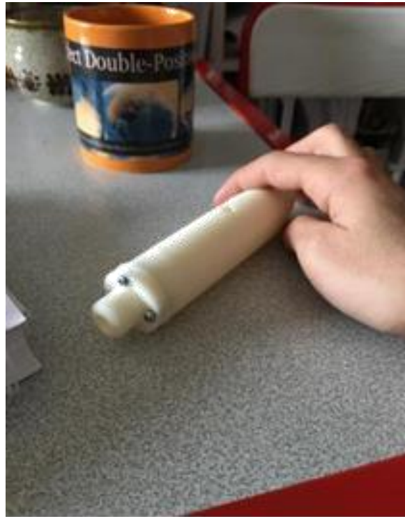
Şekil 16. Prob gövdesi üretiminde ilk çalışmalar, arka kısımla montajlı baskı
