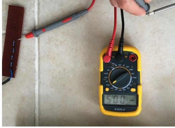
Şekil 42. 1 numaralı elektrot için alınan test ölçümü
