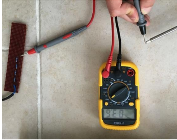
Şekil 43. 2 numaralı elektrot için alınan test ölçümü
