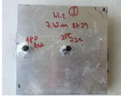
Şekil 7-26 Atışlar Sonucu Numune 3'in Ön Yüzeyi
