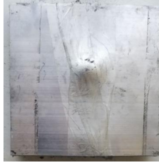
Şekil 7-28 Atışlar Sonucu Numune 3'in Arka Yüzeyi
