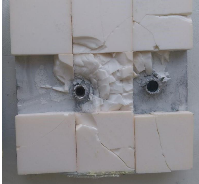
Şekil 7-18 Atışlar Sonucu Numune 1'in Seramik Yüzeyi
