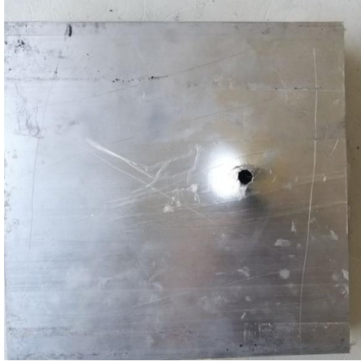
Şekil 7-21 Atışlar Sonucu Numune 2'in Arka Yüzeyi
