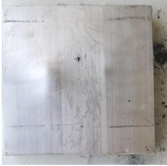
Şekil 7-33 Atışlar Sonucu Numune 3'in Arka Yüzeyi
