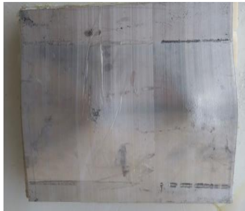
Şekil 7-16 Atışlar Sonucu Numune 1'in Arka Yüzeyi
