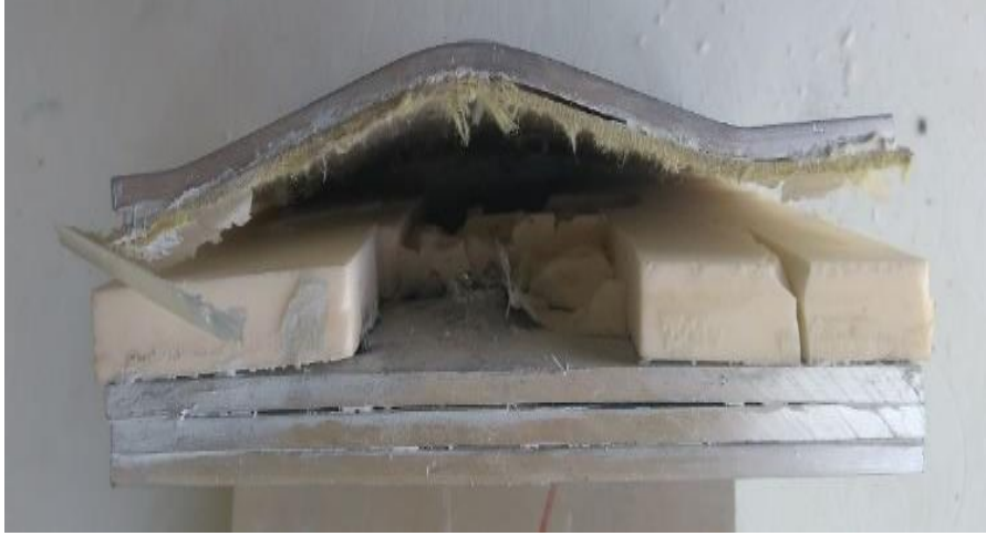
Şekil 7-17 Atışlar Sonucu Numune 1'in Kesit Görüntüsü
