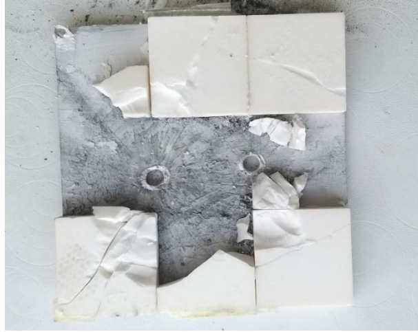
Şekil 7-34 Atışlar Sonucu Numune 3'in Seramik Yüzeyi
