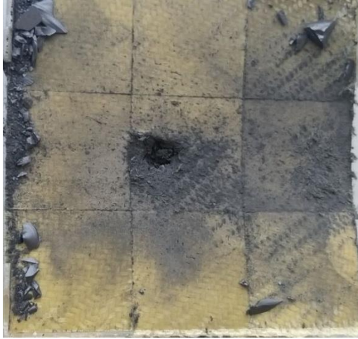
Şekil 7-29 Atışlar Sonucu Numune 3'in Kevlar Yüzeyi
