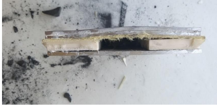
Şekil 7-32 Atışlar Sonucu Numune 3'in Kesit Görüntüsü
