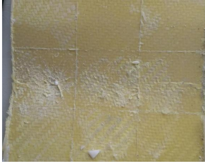
Şekil 7-19 Atışlar Sonucu Numune 1'in Kevlar Yüzeyi
