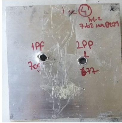
Şekil 7-31 Atışlar Sonucu Numune 4'in Ön Yüzeyi
