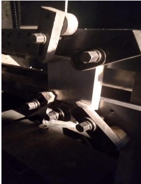
Şekil 7-10 Zırh Paketinin Atış Öncesi Bağlandığı Mekanizma
