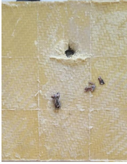
Şekil 7-22 Atışlar Sonucu Numune 2'in Kevlar Yüzeyi
