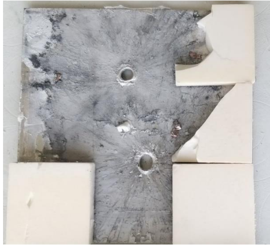
Şekil 7-25 Atışlar Sonucu Numune 2'in Seramik Yüzeyi
