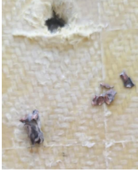
Şekil 7-23 Atışlar Sonucu Numune 2'nin Parçaladığı Merminin Kalıntıları
