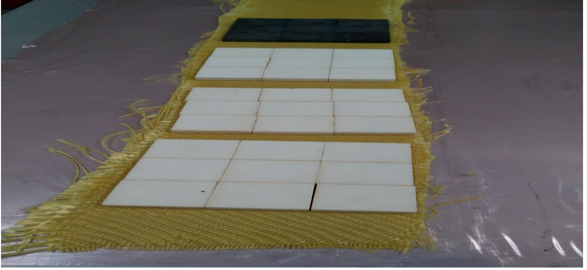
Şekil 7-5 Seramiklerin Kevlar Malzeme Üzerine Serilmiş Hali
