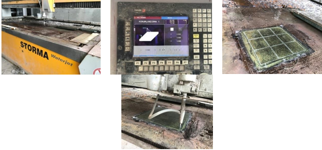
Şekil 3.26 Plaka kesim işlemi
