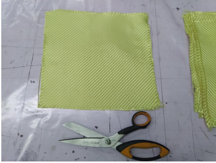
Şekil 3.18 Fiber kumaşlar kesim işlemi - 2
