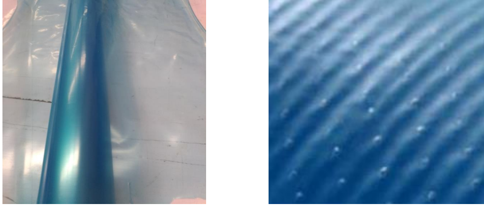
Şekil 3.6 Release film (delikli naylon)
