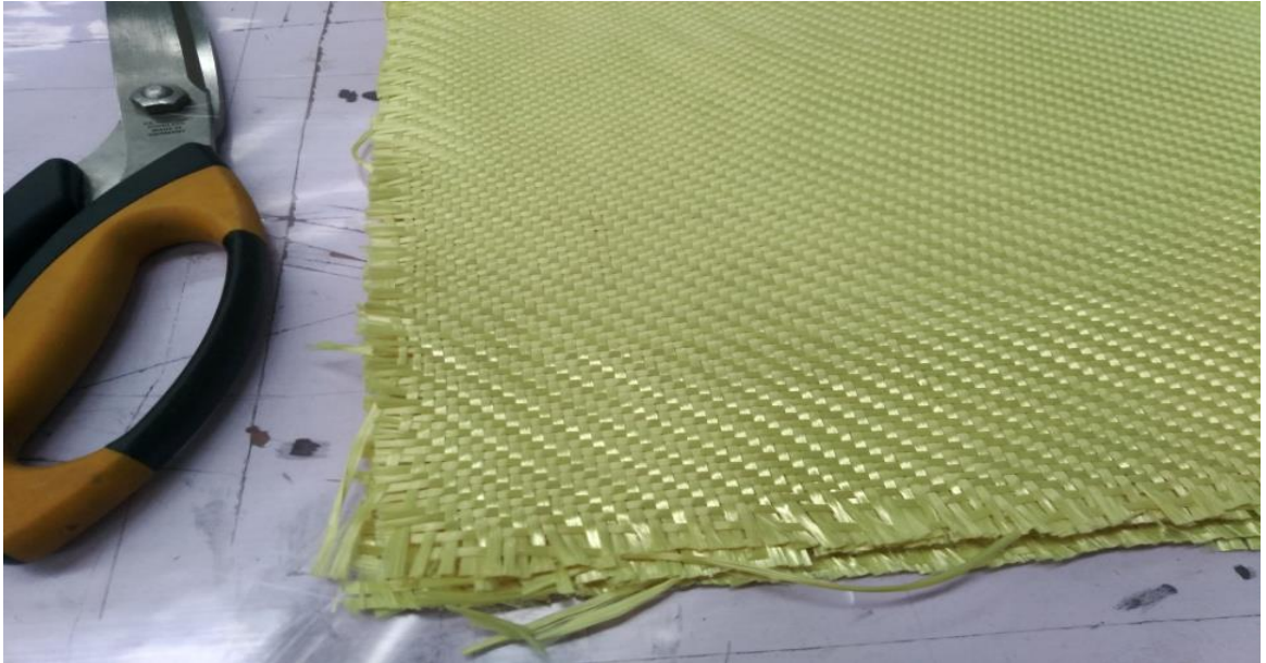
Şekil 3.1 Aramid (kevlar) fiber kumaş
