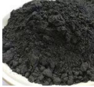
Şekil 3.13 Titanyum karbür nano-parçacıklar (TiC)
