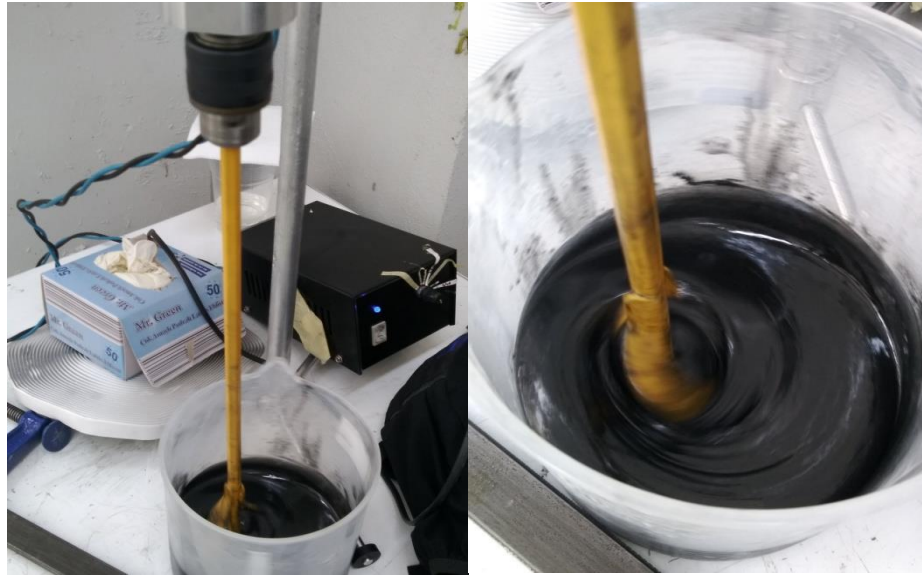
Şekil 3.24 Nano-toz karışımlarının hazırlanması
