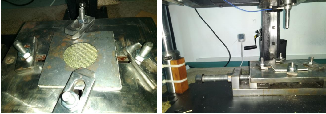
Şekil 3.29 Test numune plakalarının tutuculara bağlantısı
