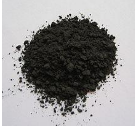
Şekil 3.14 Zirkonyum karbür nano-parçacıklar (ZrC)
