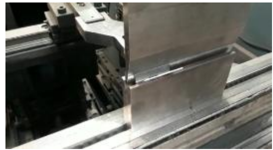
Şekil 6-5. Abkant Presin V Bükme Prosesi
