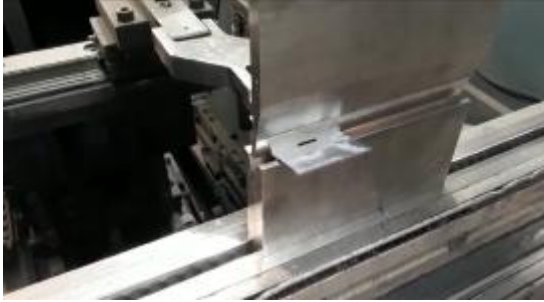
Şekil 6-5. Abkant Presin V Bükme Prosesi
