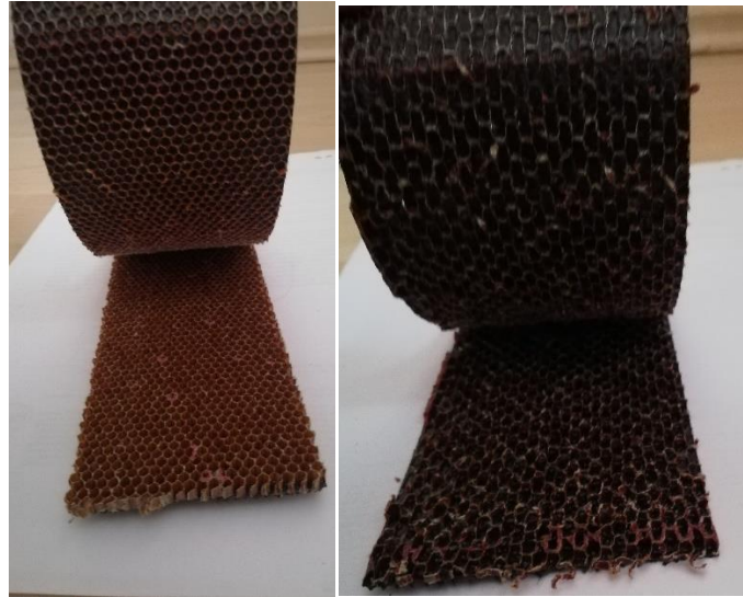
Şekil 5.36 Soyma (Peeling) Test Numuneleri
