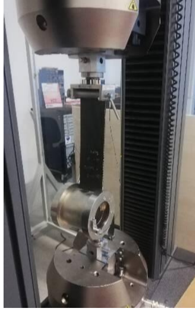
Şekil 4.21. Soyma Testi Hazırlığı
