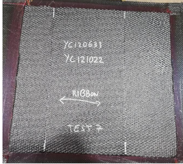
Şekil 4.12. Otoklav İşlemi Tamamlanmış Numune
