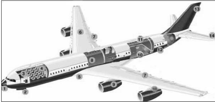
Şekil 2.22. Sandviç Yapılı Kompozitlerin Uçaklarda Kullanımı [10]
