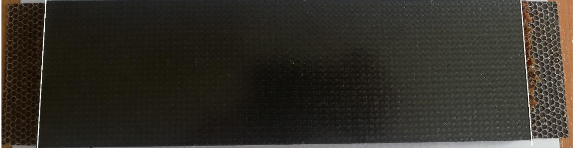
Şekil 4.22. Soyma Test Numunesi
