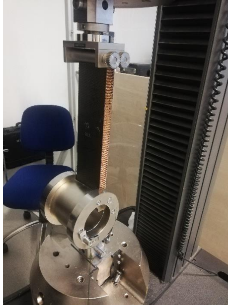
Şekil 4.30 Soyma (Peeling) Test Düzenegi
