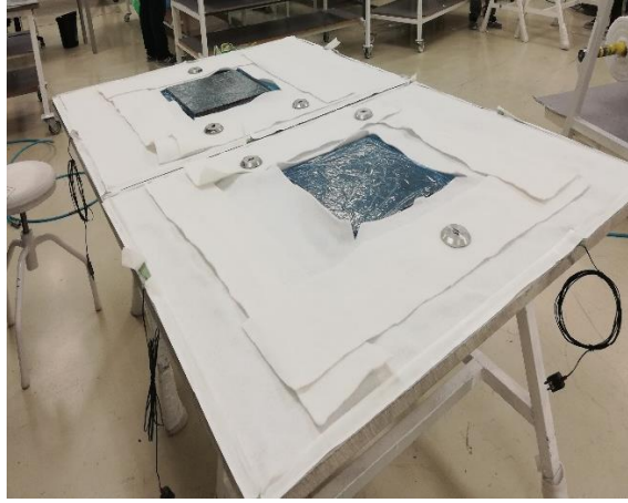
Şekil 4.10. Hava Alma Bezi Serilmesi ve Isılçift (Termokapl) Montajı
