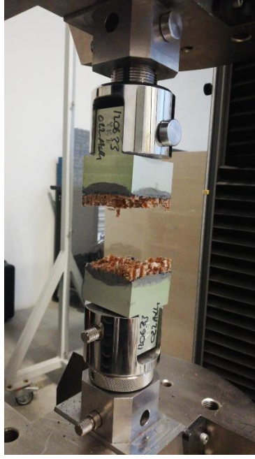
Şekil 4.27. Çekme Testi Sonlandırılması
