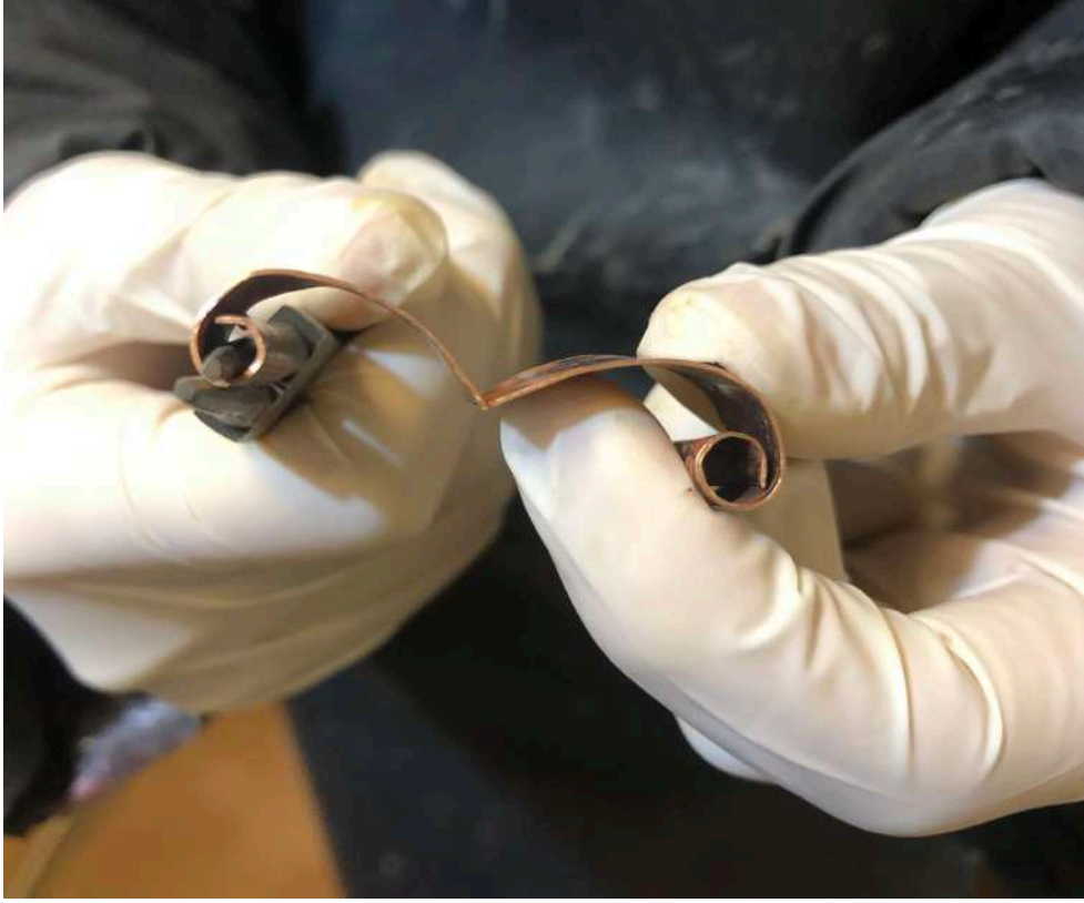
Şekil 5.22. Bakır Şeritlere Şekil Verilmesi
