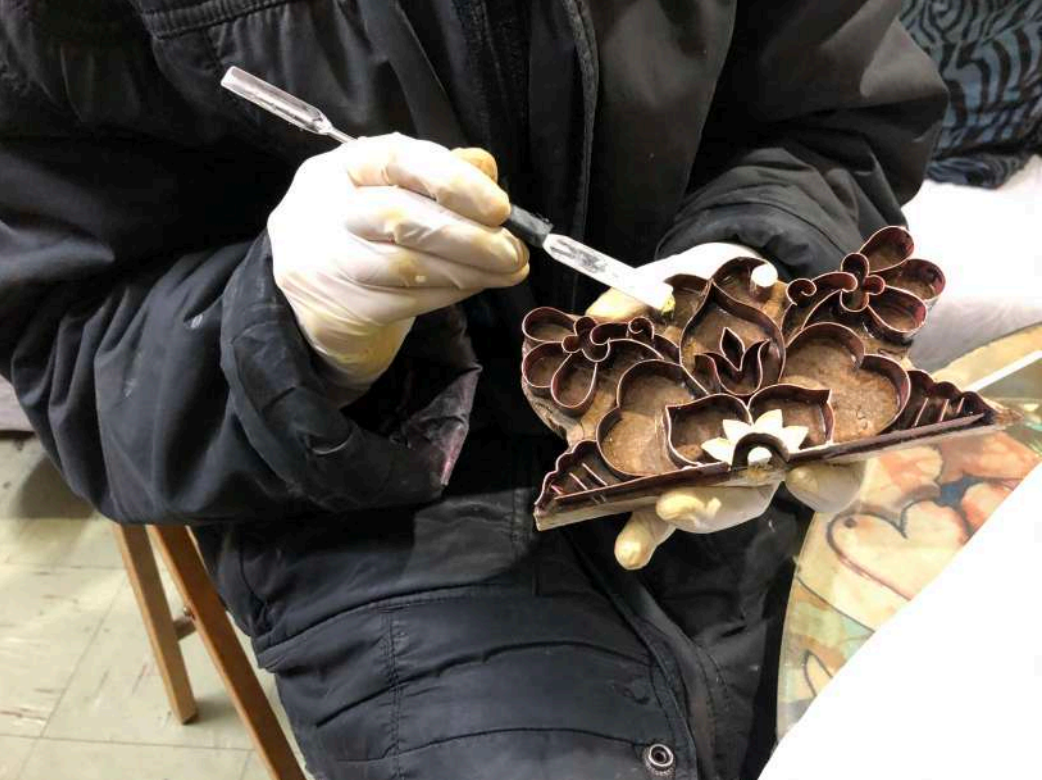
Şekil 5.37. Karılmış Porselen Alçının Spatula ile Motife Yerleştirilmesi
