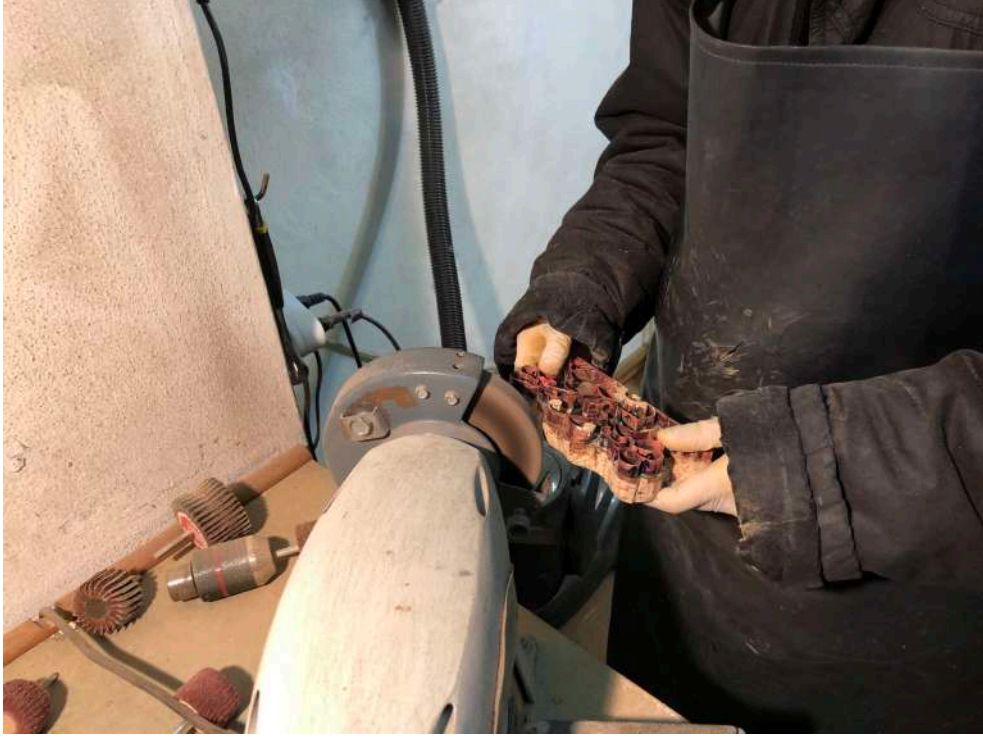
Şekil 5.38. Kalıp Kenarlarının Düzeltilmesi
