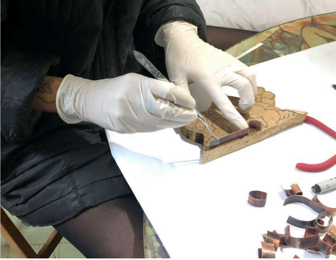
Şekil 5.29. Bakır Şeritlerin MDF Suntaya Yapıştırılması
