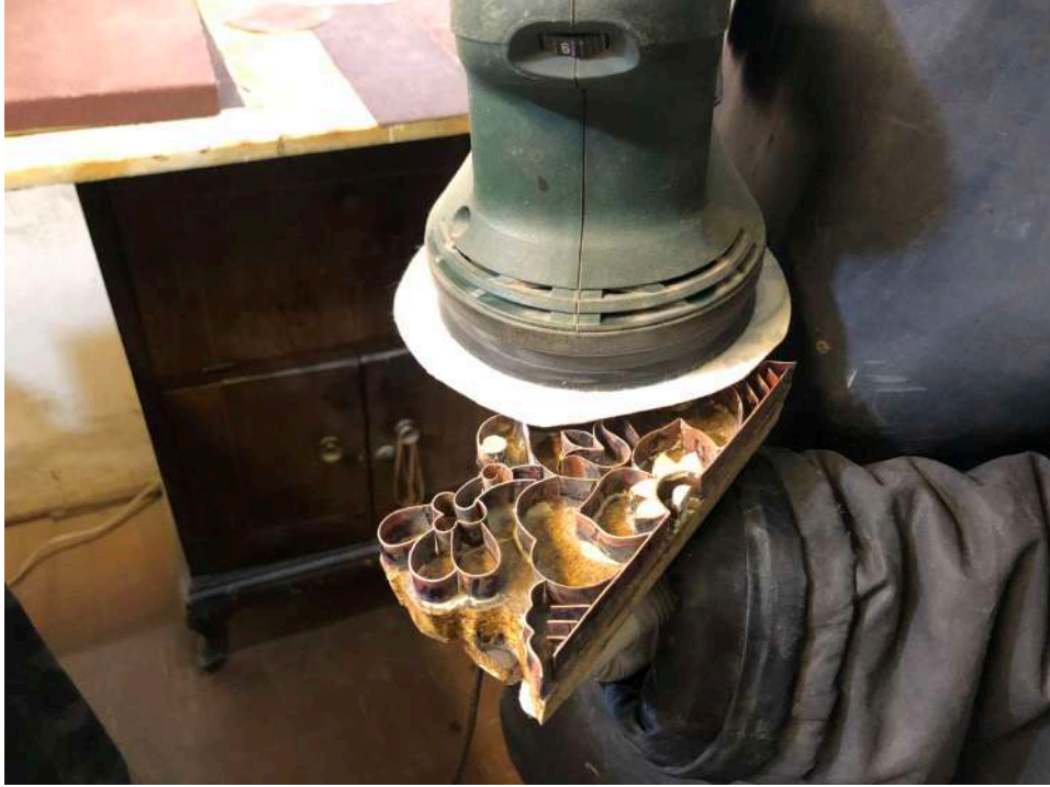
Şekil 5.42. Metal Yazma Kalıbı Yüzeyinin Yeniden Zımparalanması
