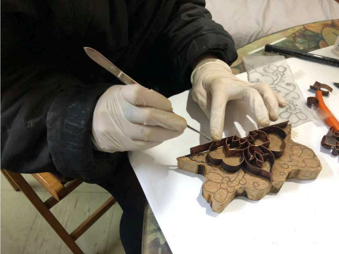
Şekil 5.30. Bakır Şeritlerin Suntaya Yapıştırılma İşlemi
