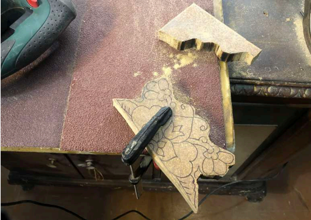
Şekil 5.28. Motifin 1 mm Dışından Kesilmiş MDF Sunta
