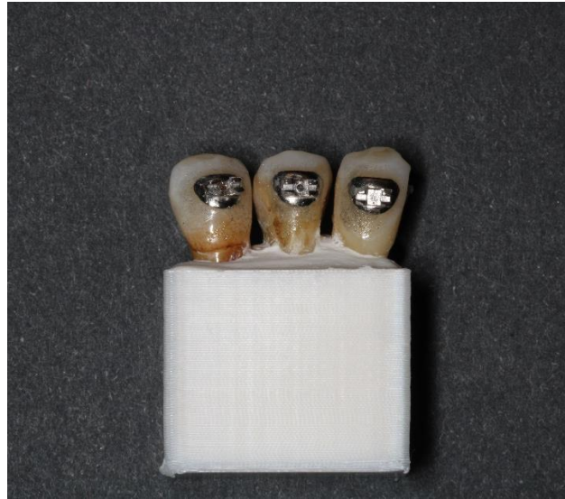
Şekil 3.17: Braket kanatları aşındırılmış 3'lü diş bloğu
