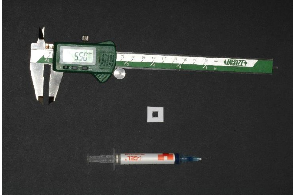
Őekil 3.3: Dental asitleme jeli (i-GEL Phosphoric Acid), orta kısmından 5,5x5,5 mm boyutlarında alan kesilerek ıkartılmıř yapıřkan kađıt, kumpas
