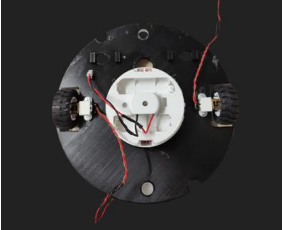
Şekil 4.1 Tekerlekler ve Vakum Aparatının Montajı
