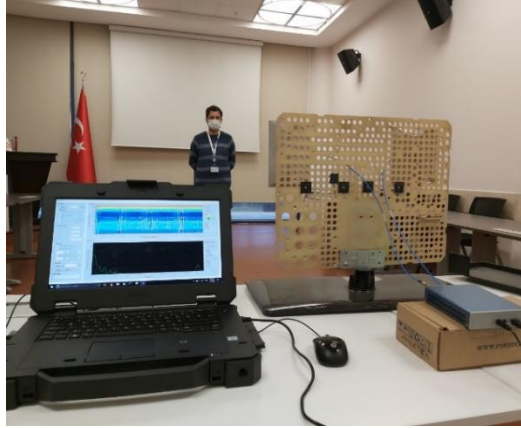
Şekil 5.24 FMCW Radar Hedef Tespiti Denepleri (Hedef 5 Metrede)
