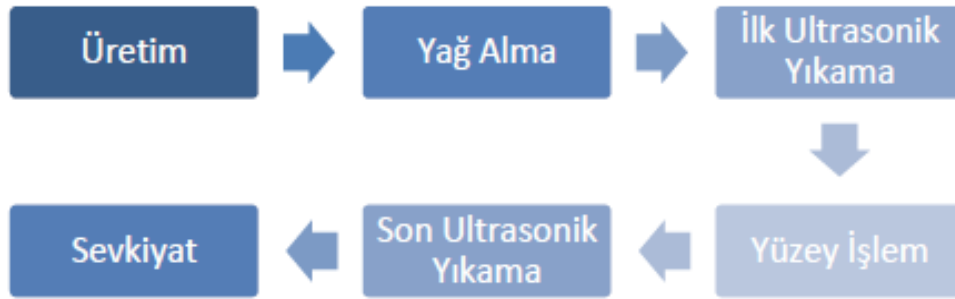
Şekil 5.1 Yıkama prosesinin işleyiş akış diyagramı
