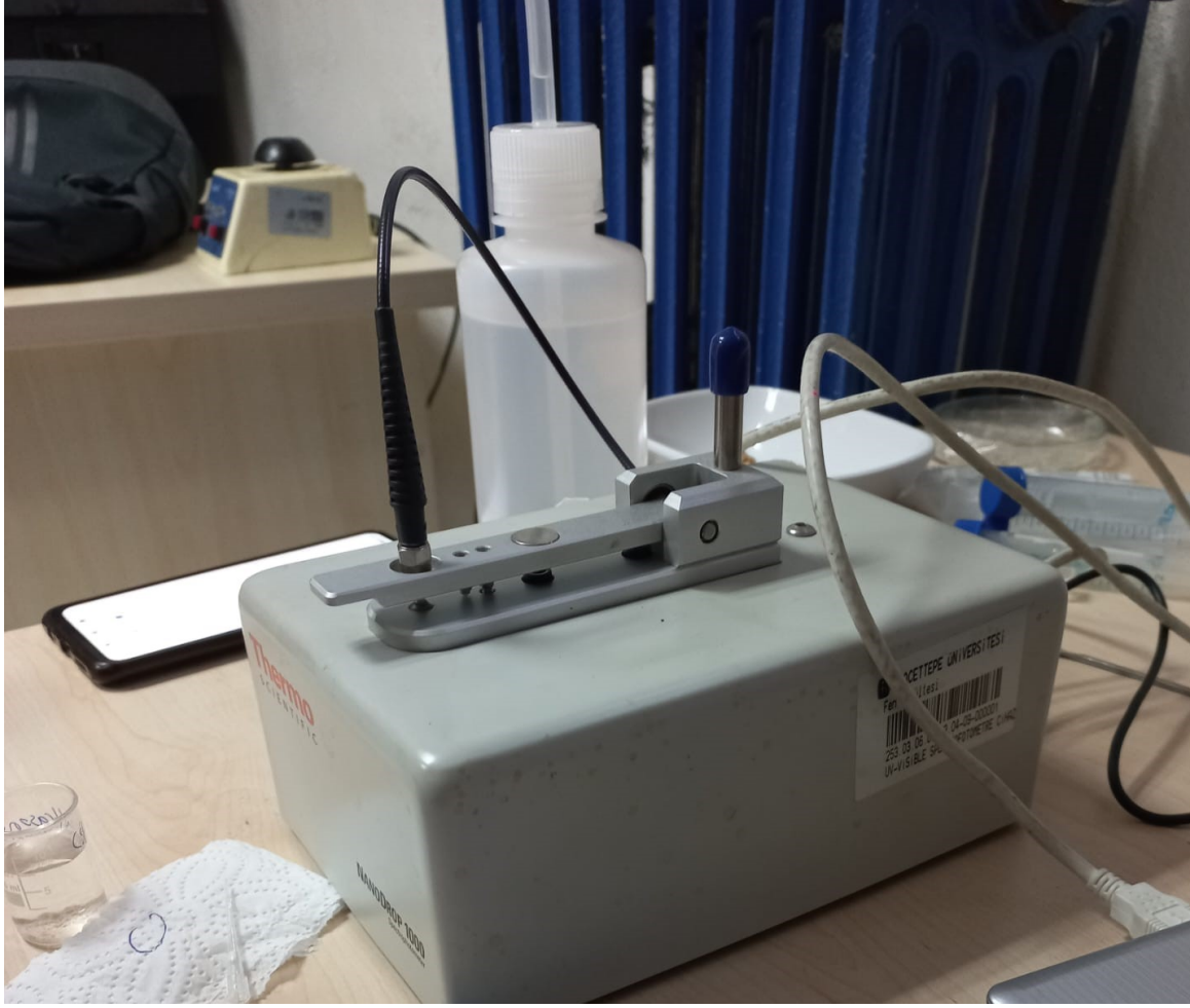
Şekil 20 Ortamdaki ilaç salınımını belirlemek amacıyla kullanılan UV-visible spektroskopi cihazı (Nanodrop)
