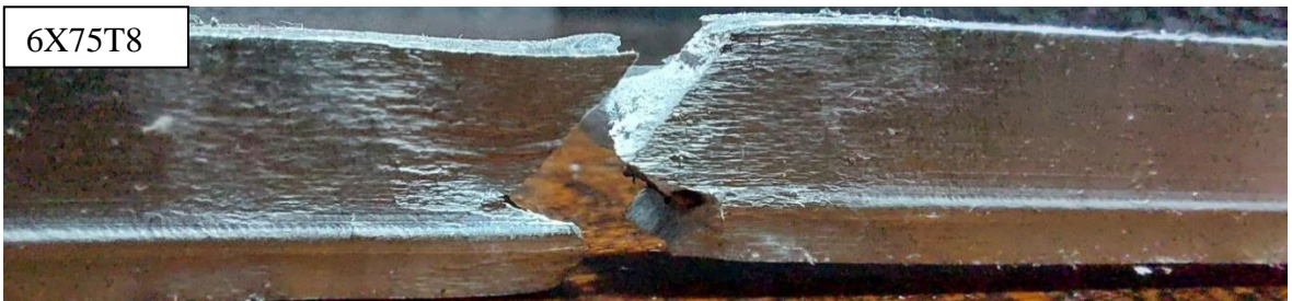
Şekil 6.33. 6X75T numuneleri kırılma fotoğraflar
