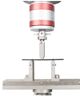
Şekil 4.3. Üç noktadan eğilme testi test düzeneği
