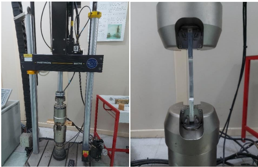
Şekil 5.12. Çekme testi test düzeneği
