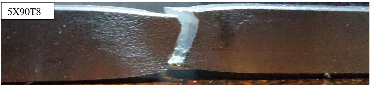
Şekil 6.27. 5X90T numuneleri kırılma fotoğraflar
