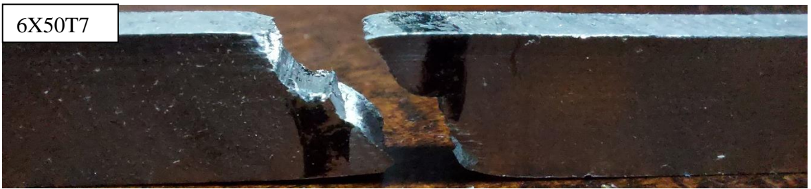
Şekil 6.30. 6X50T numuneleri kırılma fotoğraflar
