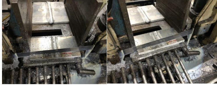
Şekil 5.7. Kaynamış numunelerin testere kesimleri
