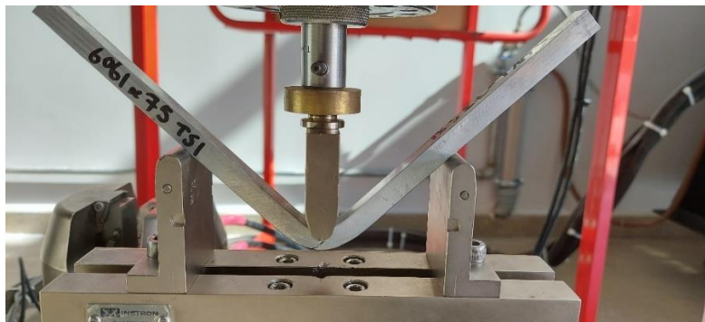
Şekil 5.13. Üç noktadan eğme testi test düzeneği
