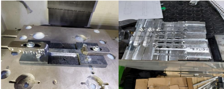
Şekil 5.8. CNC tezgahta işlenen çekme numuneleri
