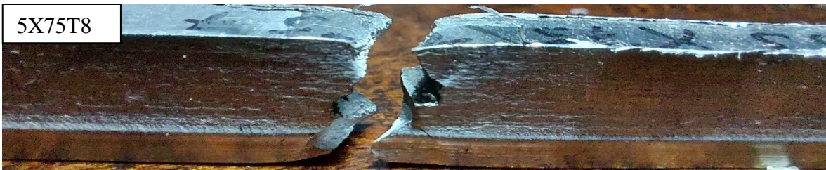
Şekil 6.24. 5X75T numuneleri kırılma fotoğrafları
