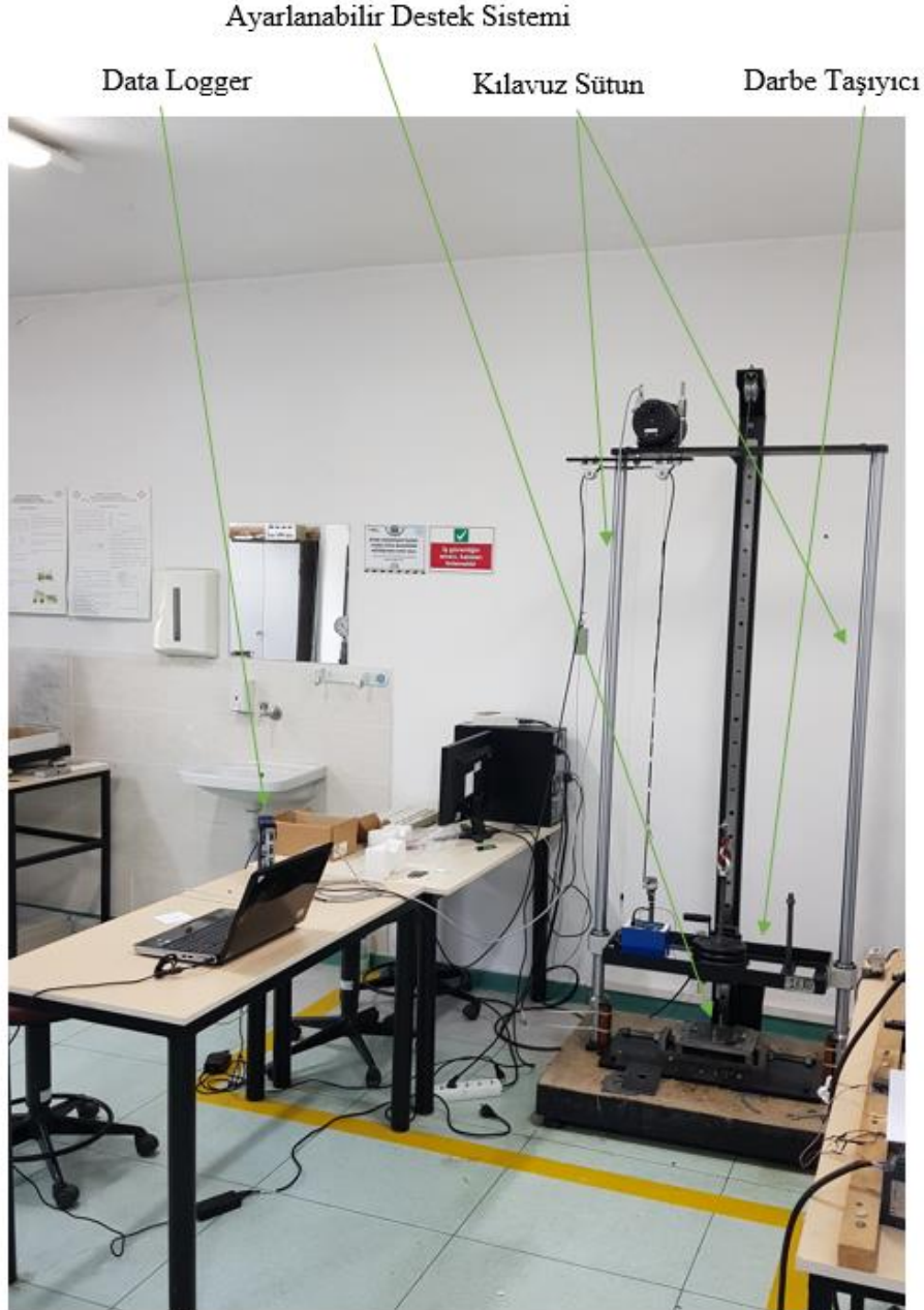
Şekil 3.8 – Düşen Ağırlık Darbe Test Cihazı
