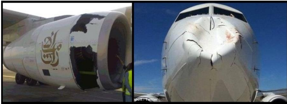
Şekil 1.7 – Uçaklardaki Sandviç Kompozit Hasarları [10]
