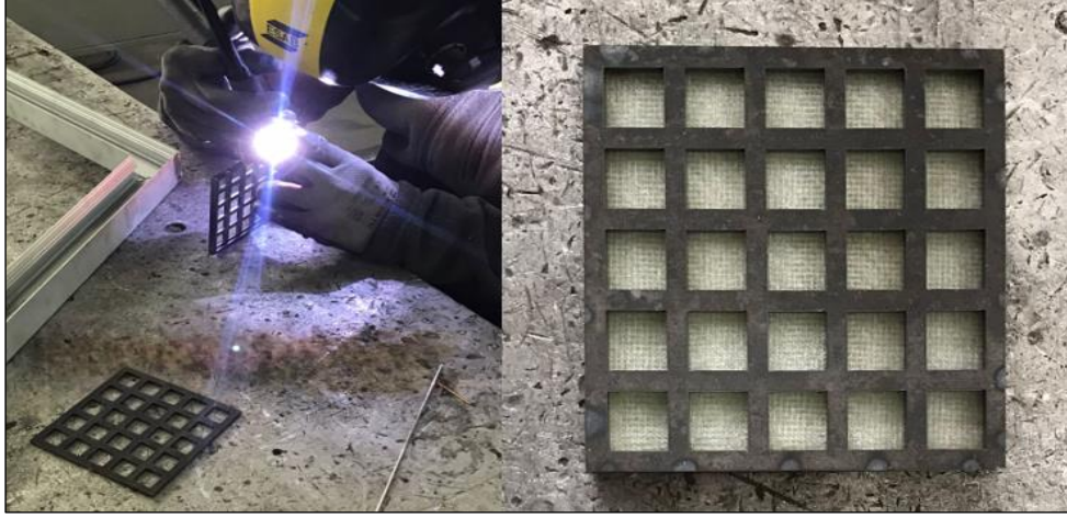
Şekil 4.36. 25 kareli, 5 mm cidar kalınlığına sahip çerçeve destekli kompozit numune
