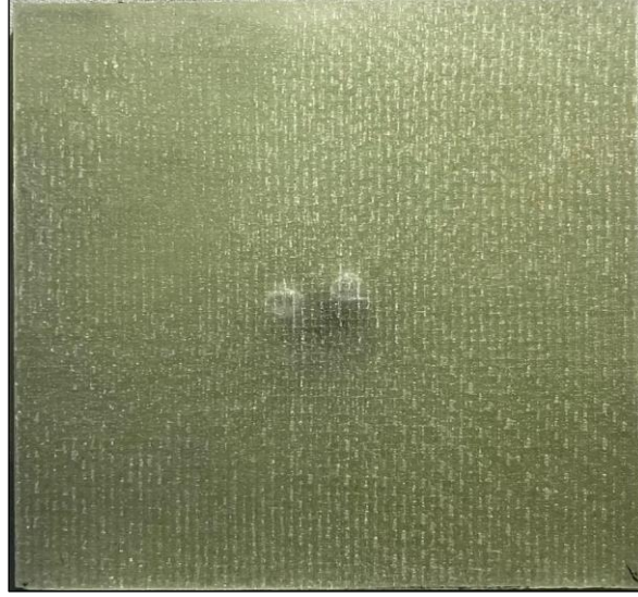
Şekil 4.64 Çerçeve desteksiz kompozit numunede darbe sonrası görüntüsü
