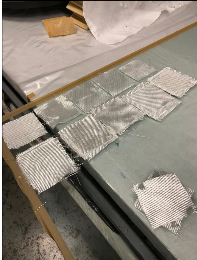
Şekil 4.23. Numunelerin imalatı için kumaşların hazırlanması
