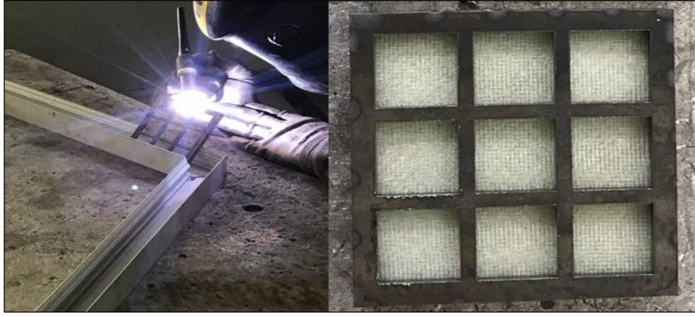
Şekil 4.34. 9 kareli, 5 mm cidar kalınlığına sahip çerçeve destekli kompozit numune
