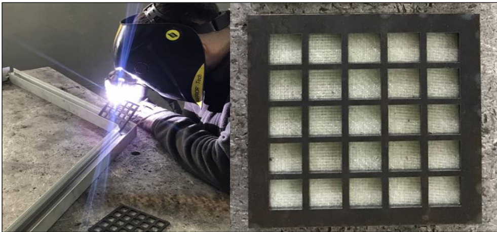
Şekil 4.35. 25 kareli, 3 mm cidar kalınlığına sahip çerçeve destekli kompozit numune
