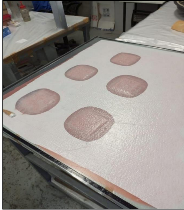
Şekil 4.27. İmalat sonrası vakum altında bekletilen 5 adet kompozit numune
