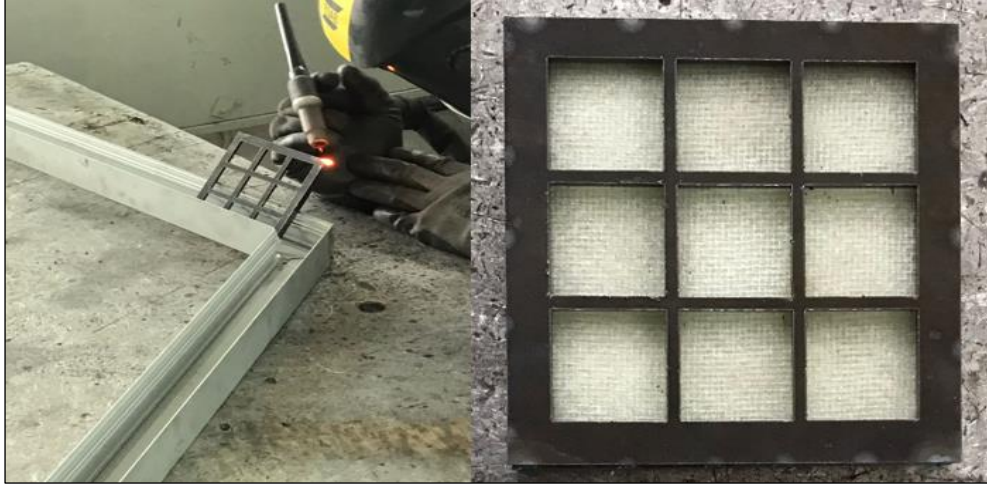
Şekil 4.33. 9 kareli, 3 mm cidar kalınlığına sahip çerçeve destekli kompozit numune
